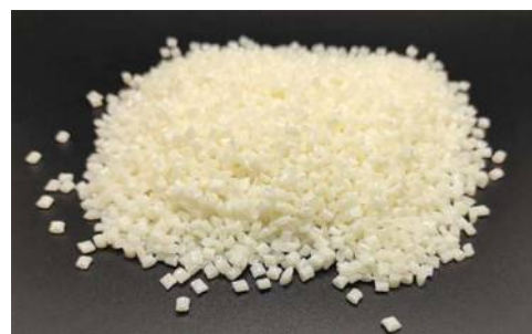
Мал. 205. Пластик у формі гранул і дроту — сировина для 3D-друку
