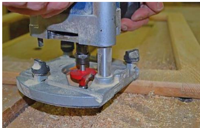
Мал. 90. Зняття радіусної фаски фрезером з деталей виробу
