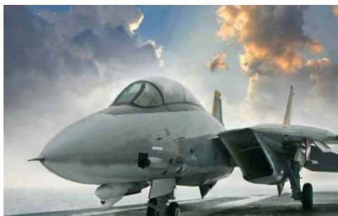
Мал. 152. Горизонтальні стабілізатори та частини обшивки винищувачів виготовлені з боропластику для опору високим навантаженням
