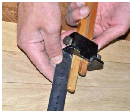
Мал. 82. Нанесення розмітки під з'єднання рейсмусом
