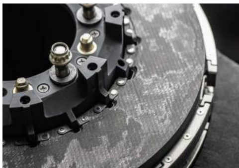
Мал. 153. Гальмівні диски з вуглецево-вуглецевих композитів
