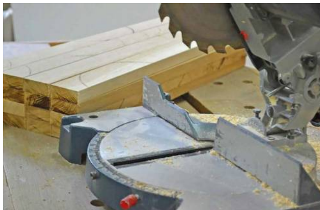
Мал. 81. Електрична пила для торцювого розкрою заготовок
