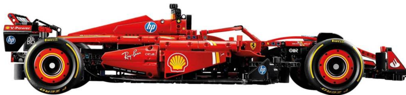
Мал. 143. Болід «Формули-1» з корпусом із вуглепластику
