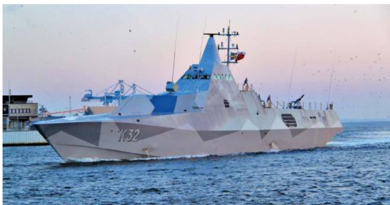
Мал. 157. Корвет типу «Вісбю» (швед. Korvett typ Visby, англ. Visby-class corvette), у складі Військово-морських сил Швеції. Корпус і надбудова шведського корвета типу «Вісбю» виконано у вигляді моноблока з оригінального композиту (набір полімерів + вуглецеве волокно й вініл). Цей матеріал забезпечив малу вагу, високу жорсткість і ударостійкість. А головне — поглинання радіохвиль, завдяки чому корвет непомітний для засобів виявлення супротивника
