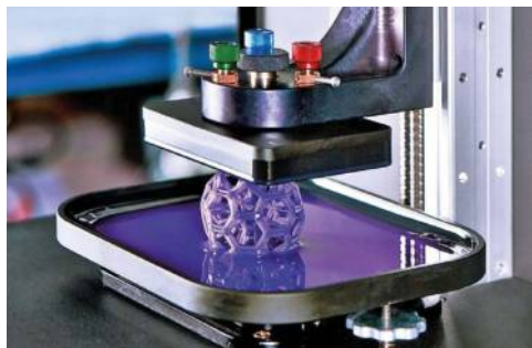
Мал. 170. 3D-друк з біопластику. Найпопулярнішим матеріалом у цій сфері є PLA (полімолочна кислота)
