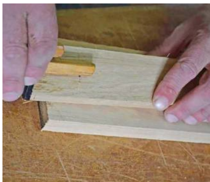
Мал. 82. Нанесення розмітки під з'єднання рейсмусом
