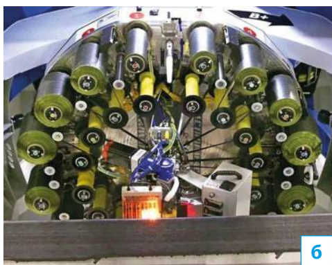
Мал. 160. а) друкувальна головка машини-робота здійснює робочий прохід; б) котушки з плівками для друку
