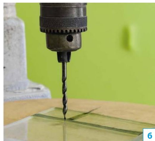
Мал. 198. Розмічання оргскла за допомогою: а) маркера; б) імпульсного паяльника для подальшого свердління; в) сітки килимка чи міліметрового паперу
