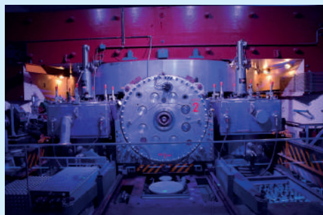
Мал. 2.2. Синхроциклотрон (прискорювач заряджених частинок) у CERN
