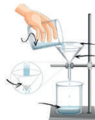
Мал. 7.3. Розділення суміші фільтруванням
