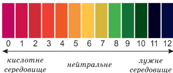
Мал. 11.1. Еталонна шкала для визначення рН
