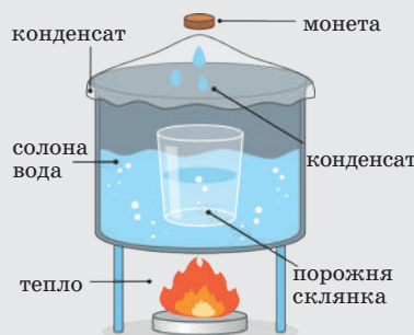
Мал. 8.5. Схема установки для опріснення води
