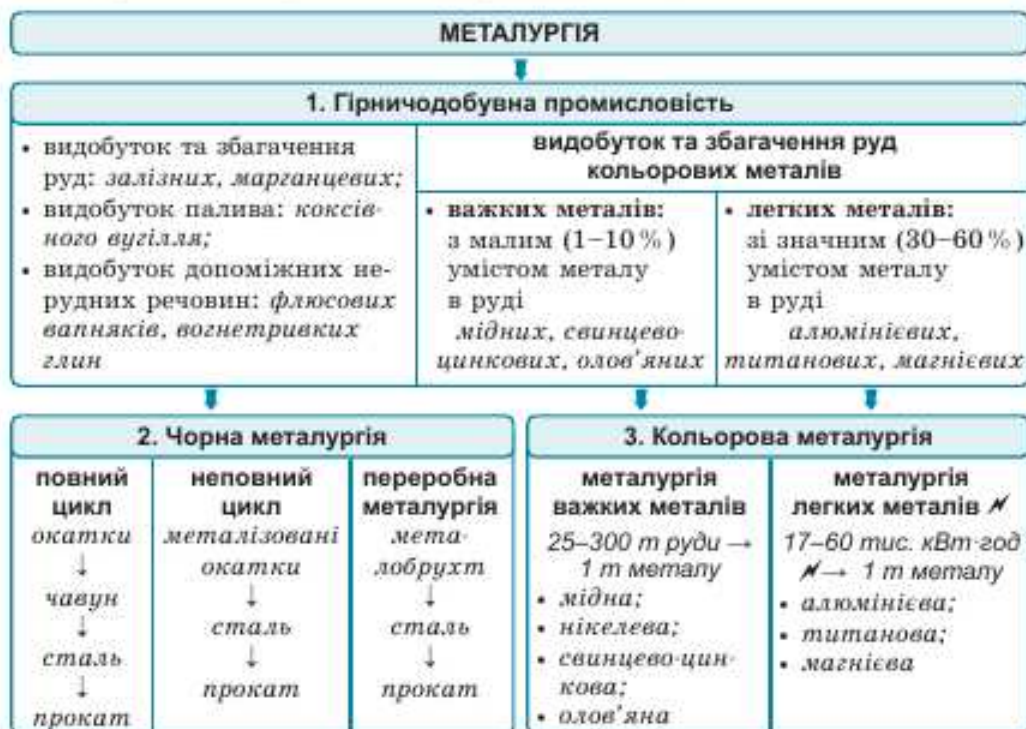
Мал. 112. Виробнича структура металургії
