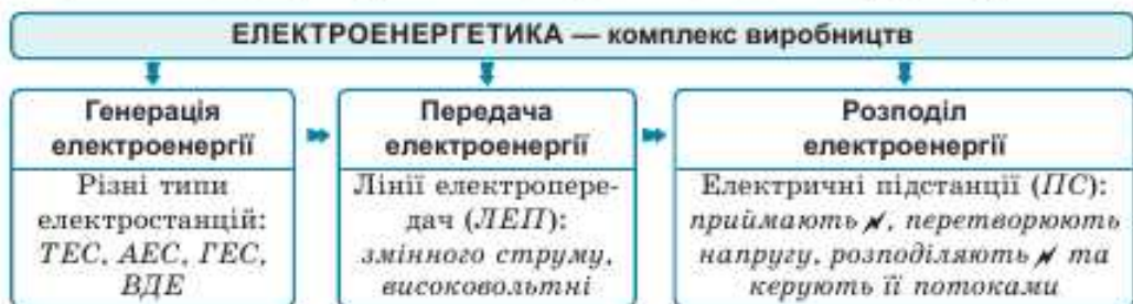
Мал. 96. Ключові стадії роботи електроенергетики
