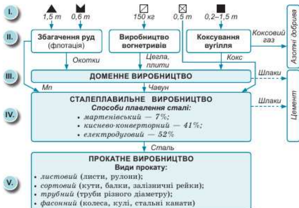
Мал. 114. Комбінат із повним металургійним циклом
