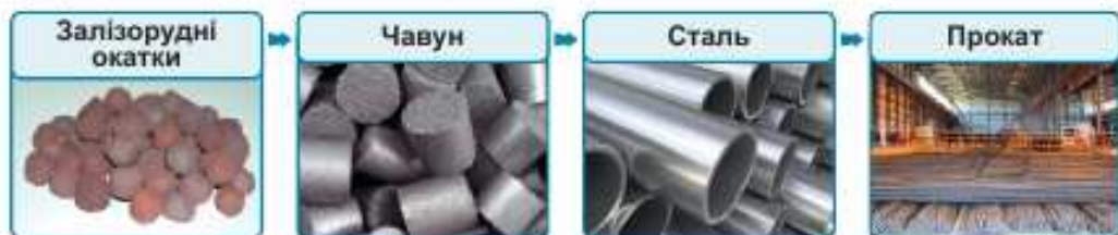
Мал. 113. Послідовність виробництва продукції на металургійному комбінаті повного циклу
