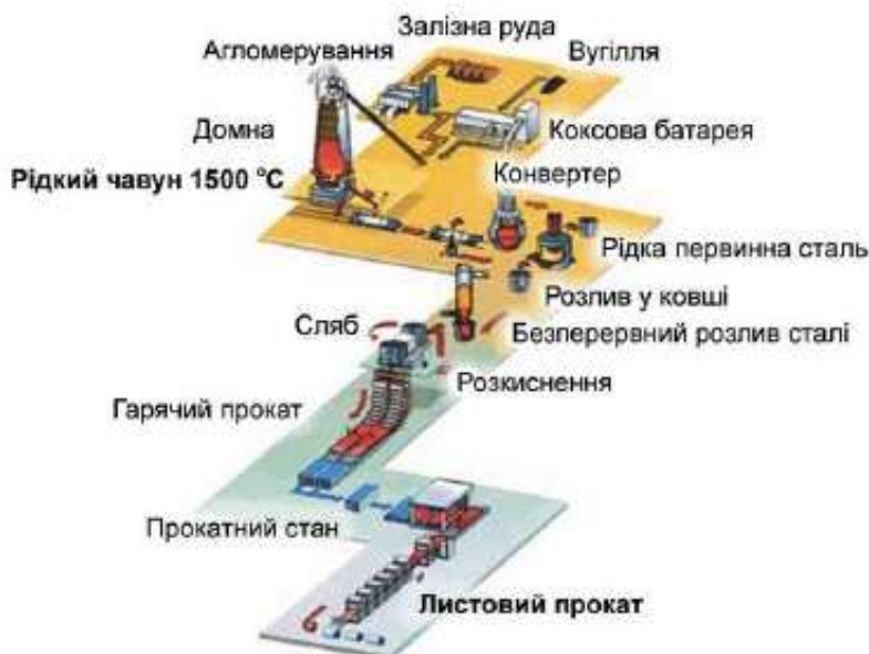
Мал. 19.4. Основні етапи виготовлення прокату чорних металів киснево-конвертерним способом
