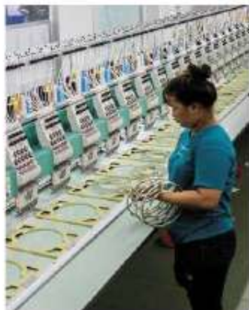
Мал. 25.5. Сучасна промислова автоматична високотехнологічна швейна машина для виготовлення одягу
