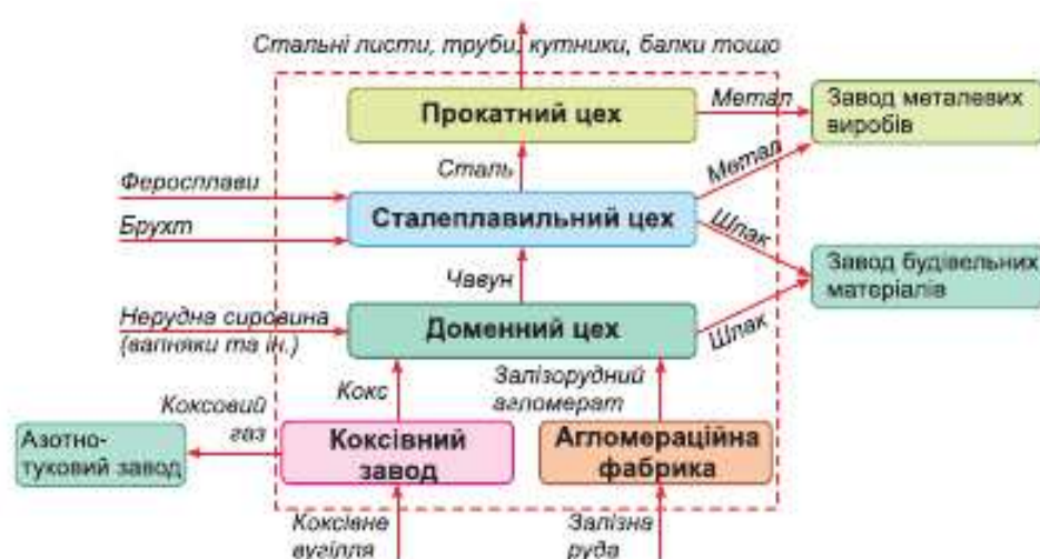
Мал. 27.2. Схема металургійного комбінату повного циклу
