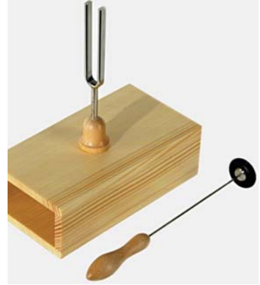
Мал. 14.1. Камертон з резонатором і молоточком
