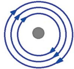
Мал. 4.7. Лінії магнітного поля провідника зі струмом
