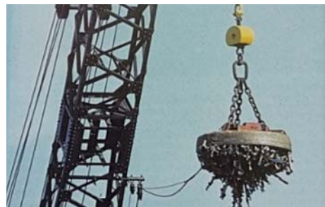
Мал. 7.5. Підйомальний кран з електромагнітом
