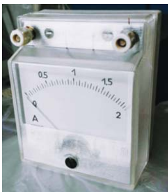
Мал. 8.8. Амперметр постійного струму
