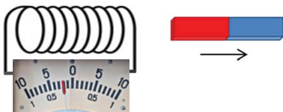
Мал. 9.5. Магніт повільно виводять із котушки
