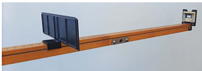
Мал. 23.7. Прилад для спостереження дифракції світла
