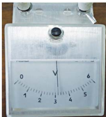
Мал. 8.9. Вольтметр постійного струму
