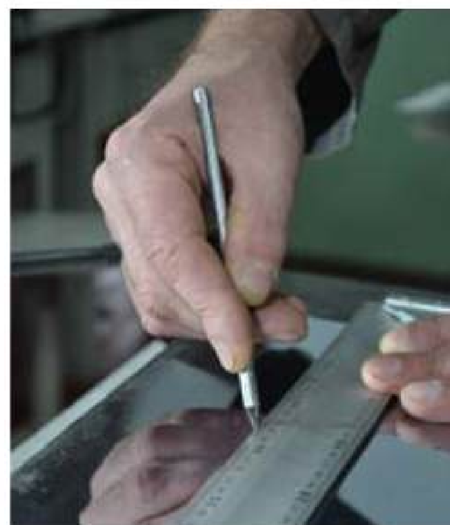
Мал. 122. Позначення точок на базових лініях для подальшого розмічання
