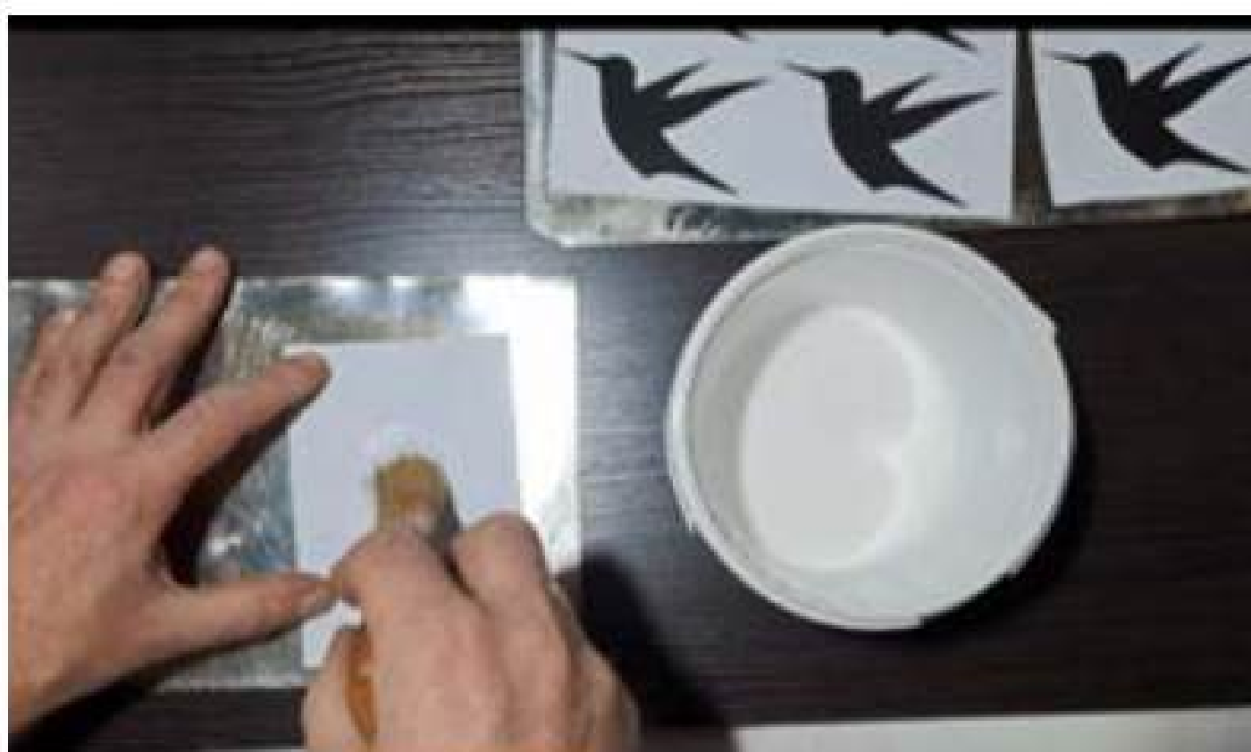
Мал. 126. Розмічання за допомогою друкованого шаблону
