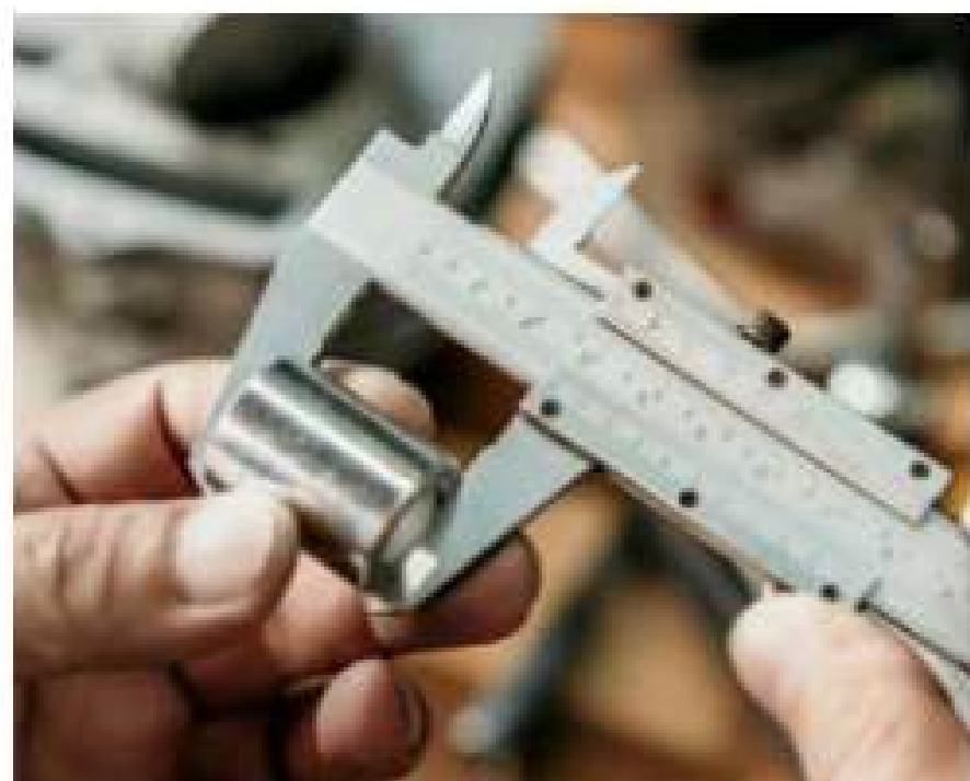
Мал. 133. Вимірювання деталей штангенциркулем
