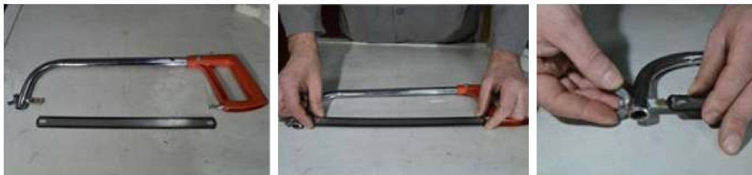
Мал. 129. Встановлення полотна слюсарної ножівки
