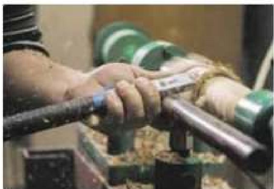
Мал. 10.22. Працювати стамесками треба плавно, без ривків і сильного натиску
