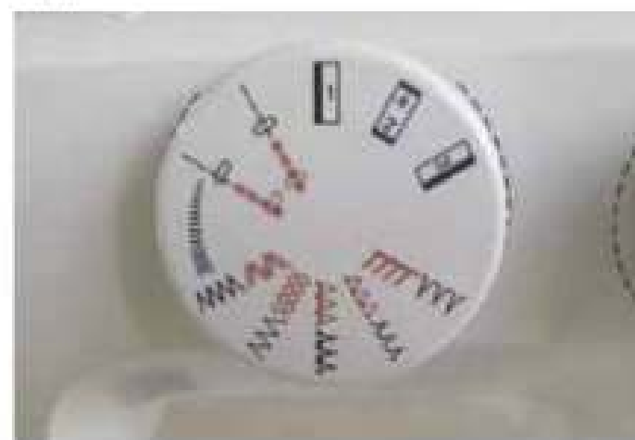
Мал. 14.17. Позначення на регуляторі для виконання петлі (напівавтомат)
