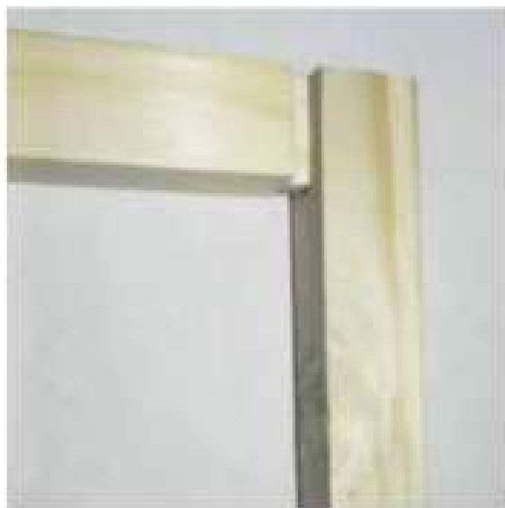
Мал. 11.2. Кутове кінцеве з'єднання
