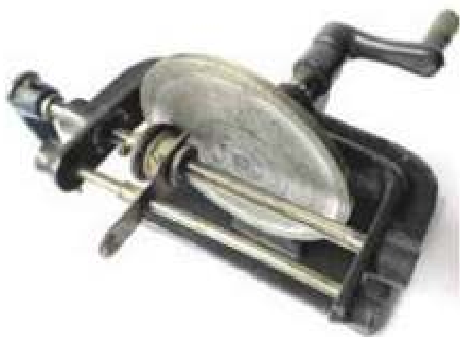
Мал. 9.3. Фрикційна передача з пружиною (модель)
