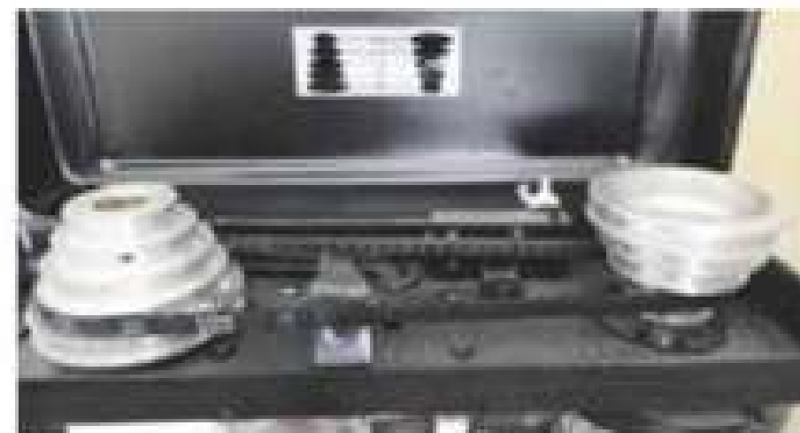
Мал. 9.6. Пасова передача свердлильного верстата
