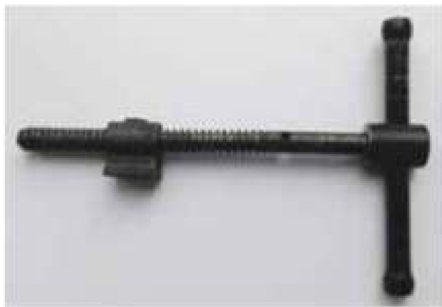
Мал. 9.15. Гвинтовий механізм слюсарних лещат
