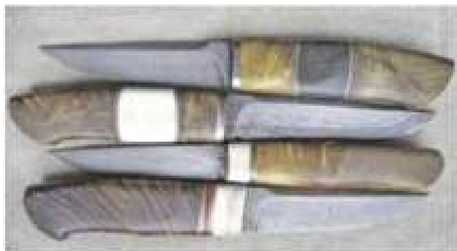
Мал. 3.3. Леза ножів виготовлені з булатної сталі
