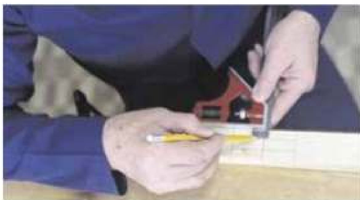
Мал. 11.14. Нанесення лінії розмітки одночасно на дві заготовки
