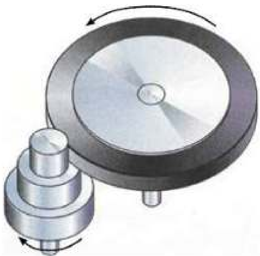
Мал. 9.4. Використання гумового валика у фрикційній передачі
