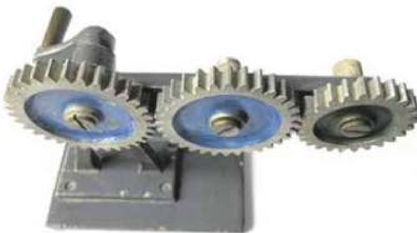
Мал. 9.14. Паразитна шестерня (модель)
