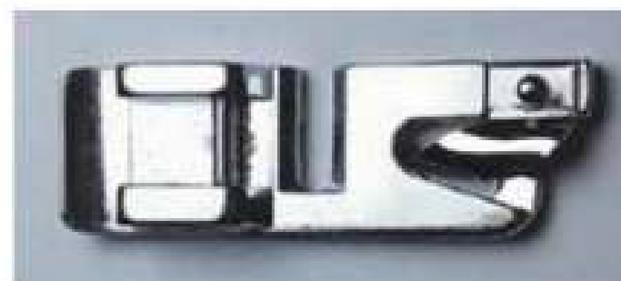
Мал. 14.10. Лапка для підгину зрізу виробу
