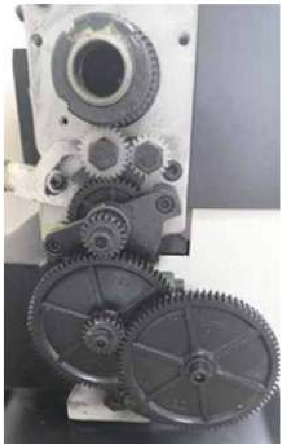
Мал. 9.10. Гітарний механізм токарного верстата
