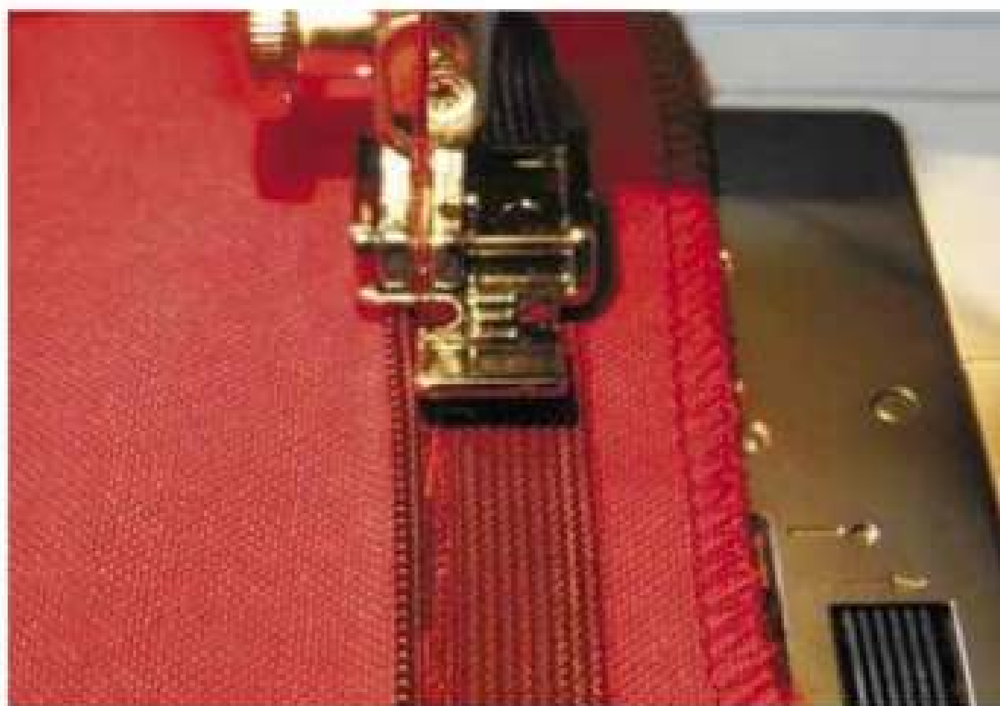
Мал. 14.12. Вшивання застібки «змійка» за допомогою спеціальної лапки
