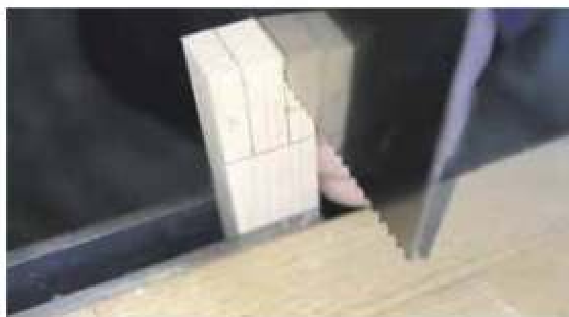
Мал. 11.15. У процесі випилювання шипа ножівка має проходити із зовнішнього боку лінії розмітки
