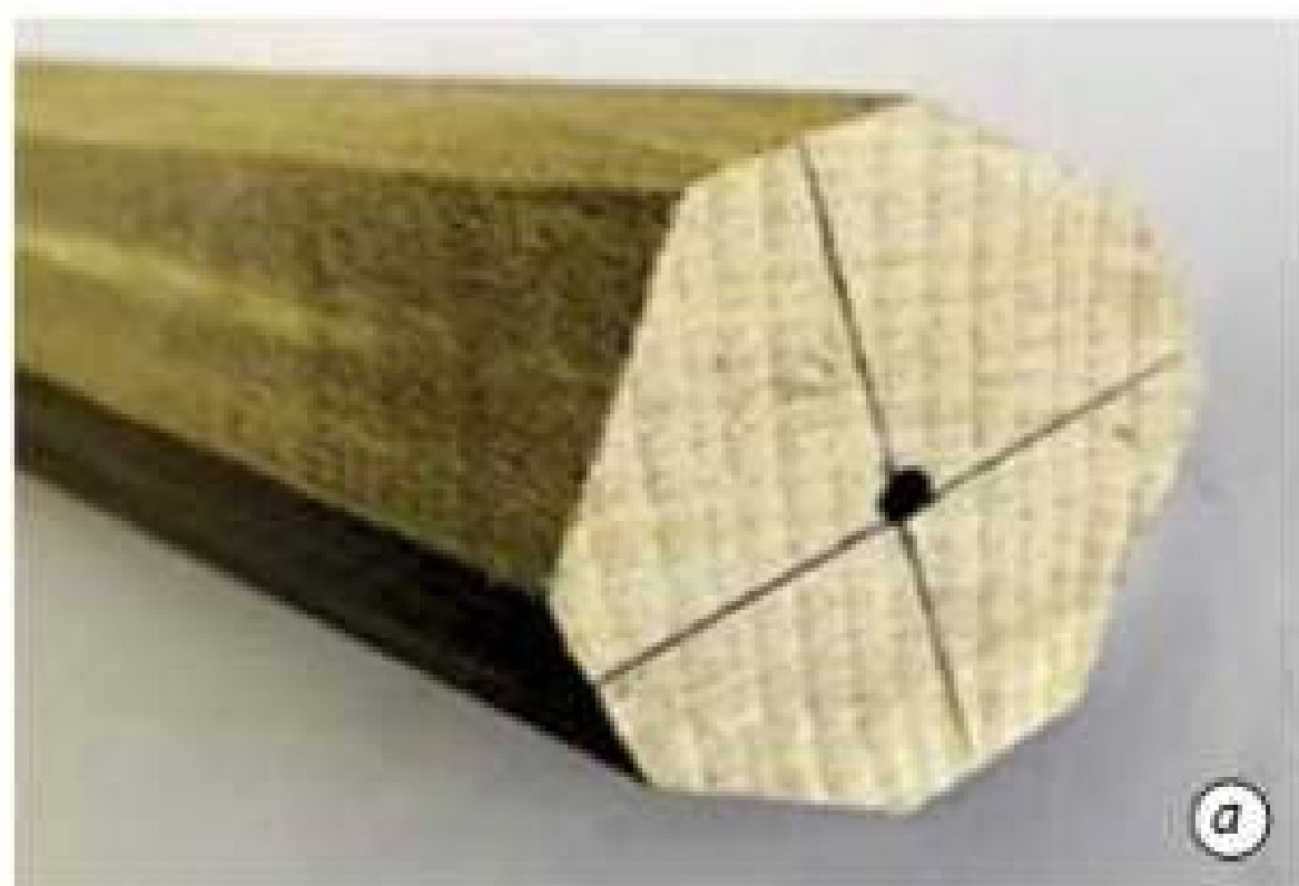
Мал. 10.14. Підготовка заготовки для точіння
