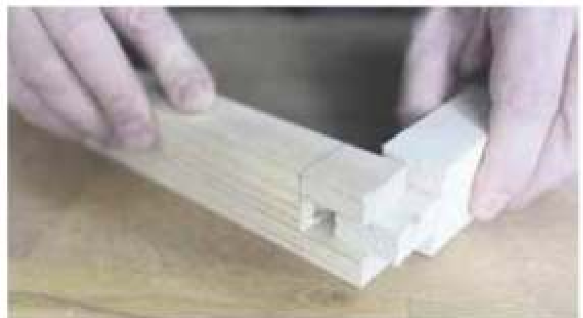
Мал. 11.24. Так перевіряють якість з'єднання деталей
