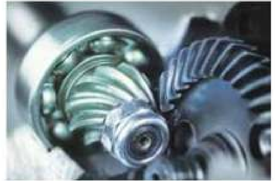
Мал. 9.11. Конічна (косозуба) зубчаста передача
