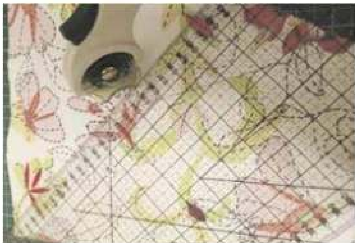
Мал. 13.13. Під час розкроювання часто використовують розкroєний дисковий ніж та килимок із нанесеними розмітками
