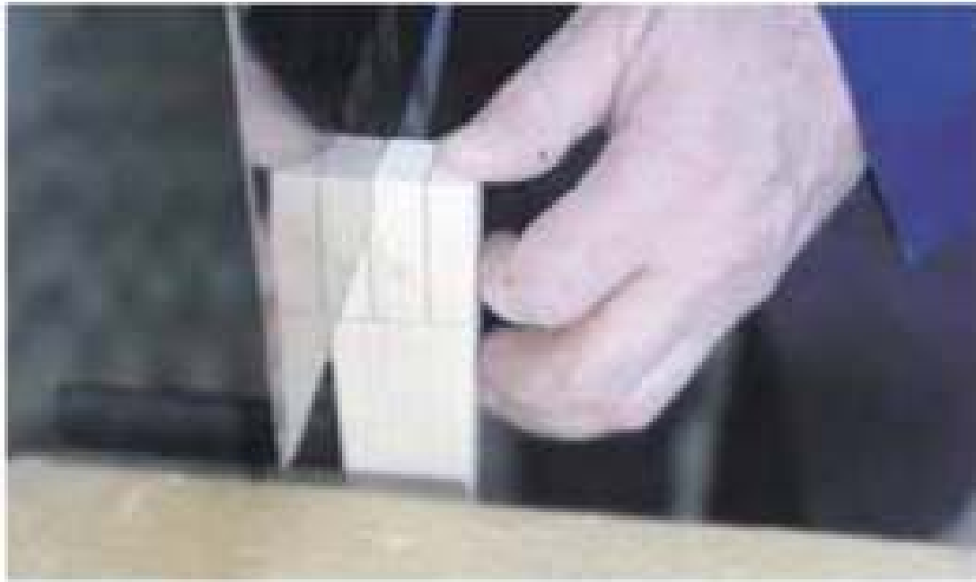
Мал. 11.16. Під час випилювання провушини ножівка має проходити з внутрішнього боку
