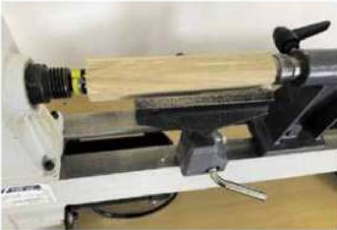
Мал. 10.15. Кріплення заготовки у верстаті
