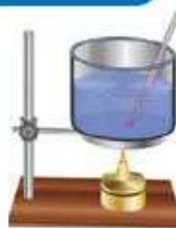
Рис. 6.25. Вимірювання підвищення температури під час спалювання рідкого палива
