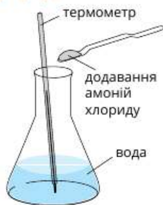
Рис. 6.35. Вимірювання зміни температури у разі додавання амоній хлориду до води
