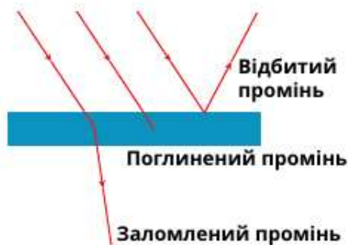
Рис. 9.6. Заломлення, поглинання та відбивання світлового променя
