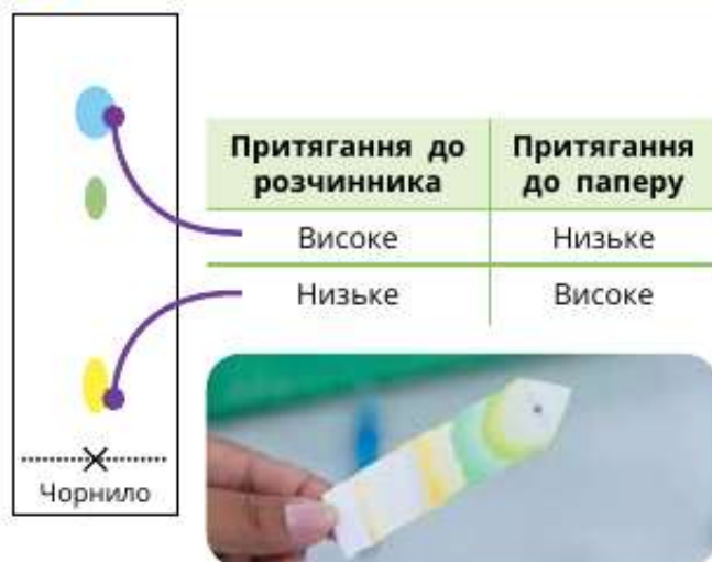
Рис. 4.16. Положення барвника залежить від його притягання до розчинника та паперу
