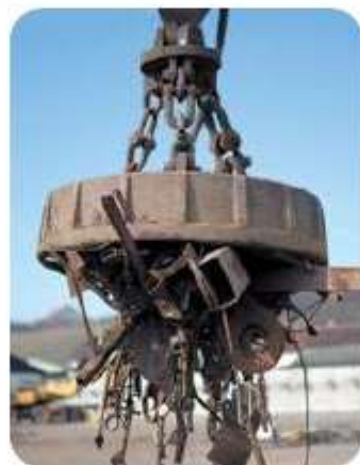
Рис. 10.19. Електромагніт піднімального крана
