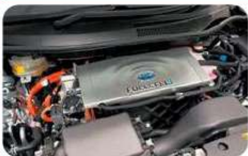
Рис. 6.24. Деякі електромобілі використовують воднево-кисневі паливні елементи замість акумуляторних батарей
