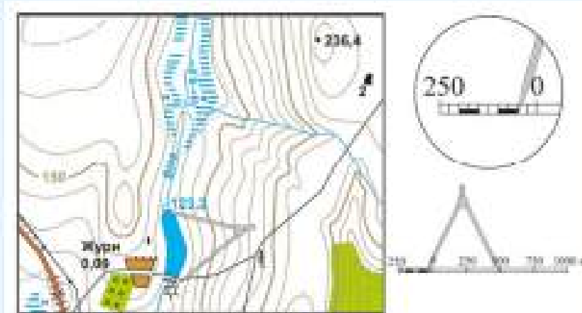
Мал. 44. Визначення довжини відрізка за допомогою циркуля-вимірювача та лінійного масштабу
