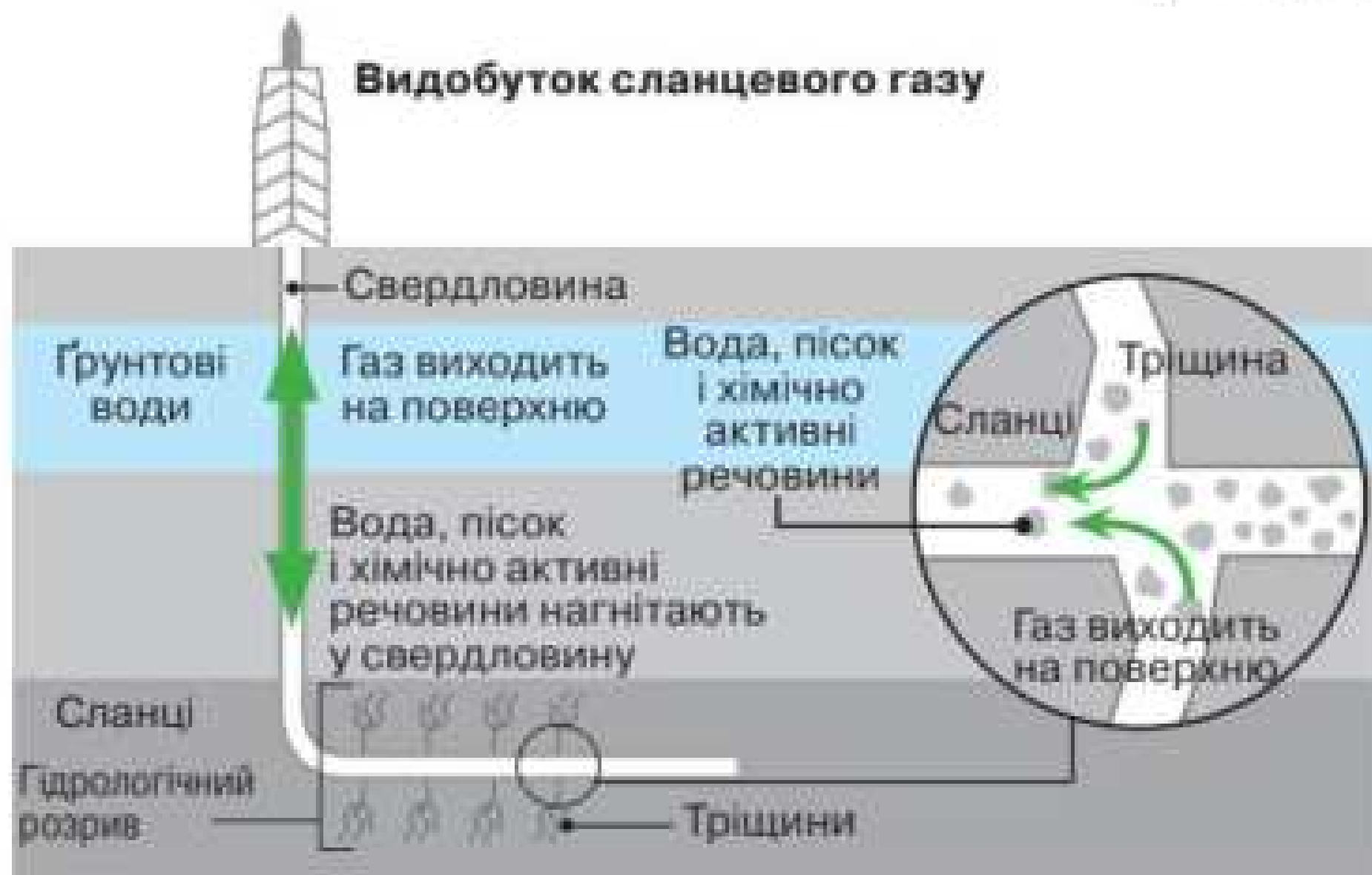
Мал. 14.4. Технологічна схема видобутку сланцевого газу методом гідророзриву пласта
