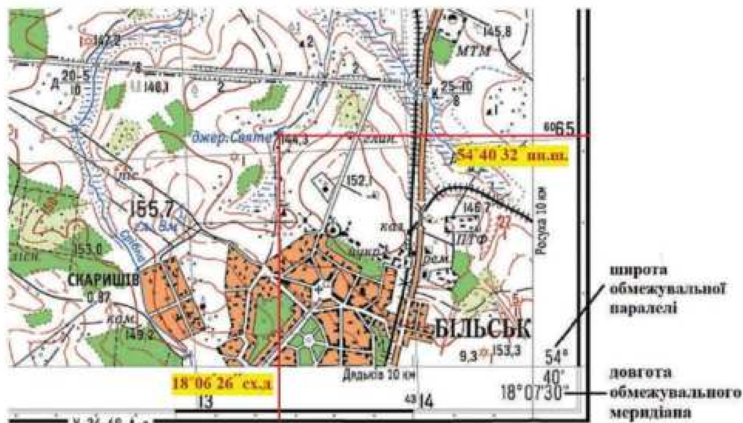
Мал. 8.2. Визначення географічних координат точки на топографічній карті
