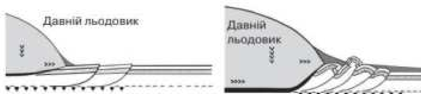
Мал. 11.6. Схема утворення гляціодислокацій на прикладі Канівських гір
