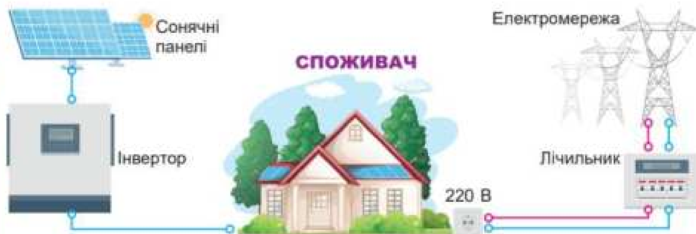
Мал. 50.4. Схема сонячної електростанції на приватному будинку
