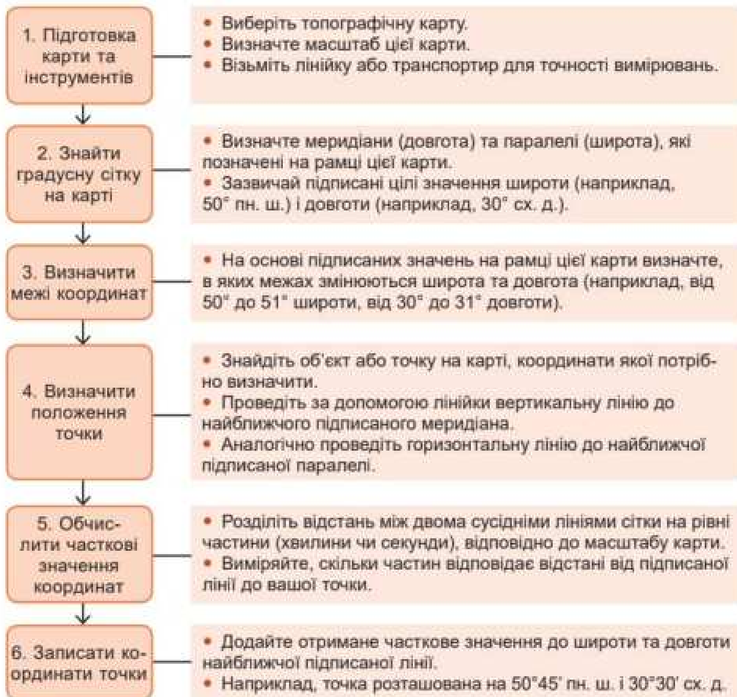
Мал. 10.1. Алгоритм визначення географічних координат на топографічних картах
