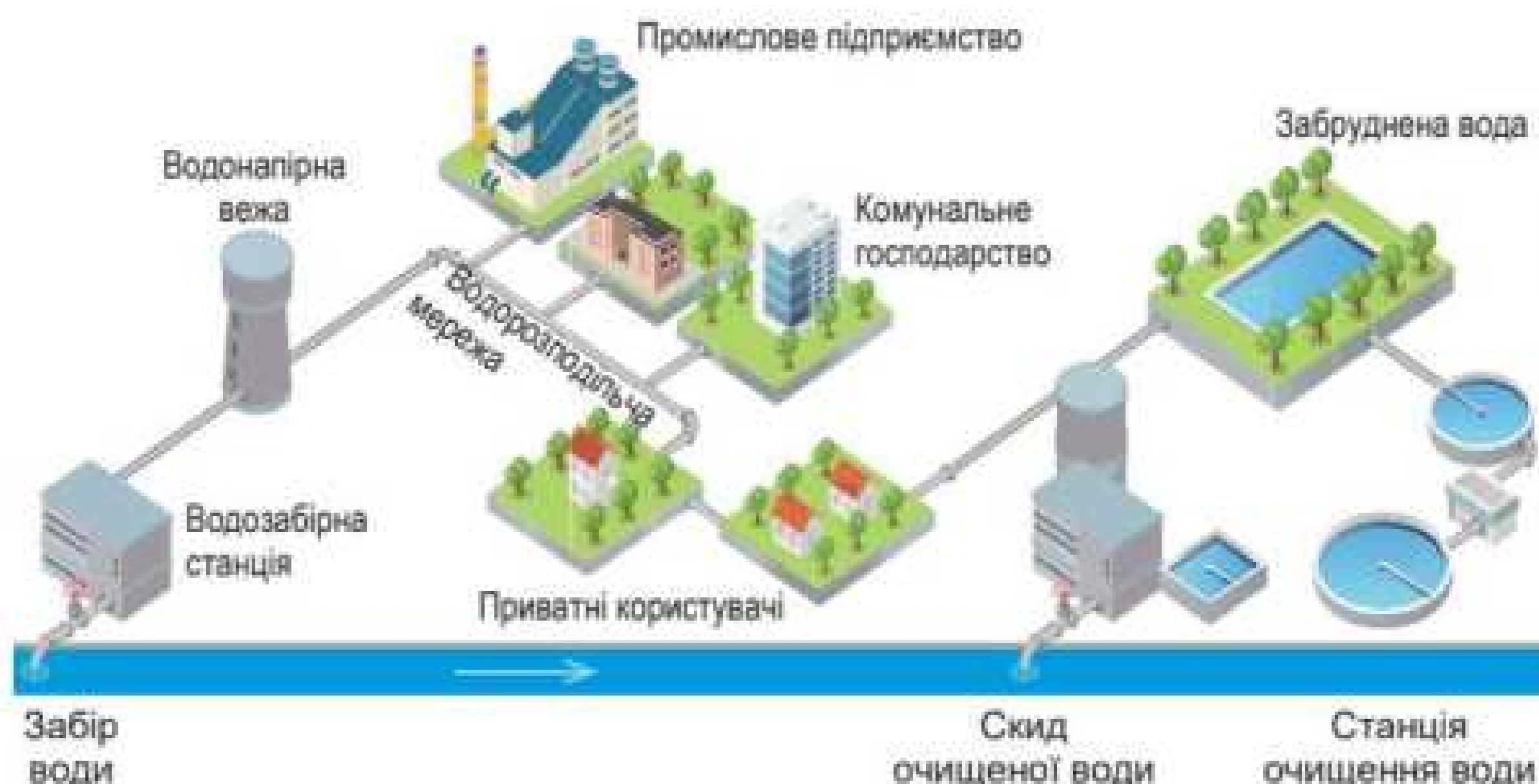
Мал. 51.3. Водокористування і водовідведення при централізованому водопостачанні
