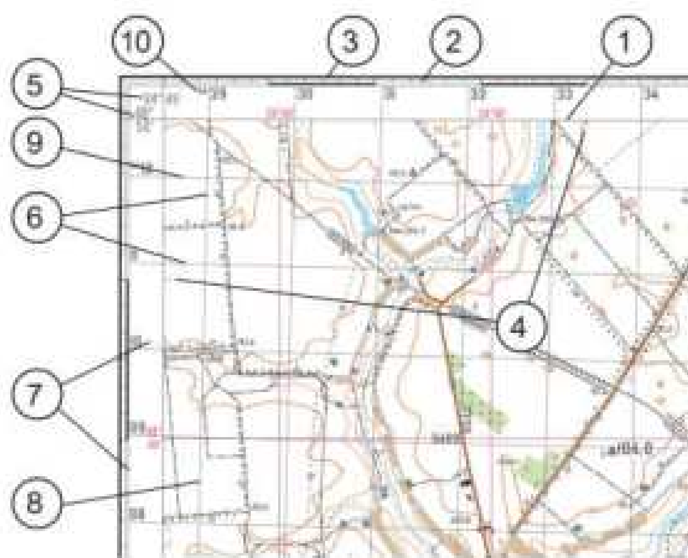
Мал. 8.10. Елементи математичної основи топографічної карти масштабу 1 : 100 000. Цифрами позначено: 1 – внутрішня рамка карти, 2 – мінутна рамка, 3 – зовнішня рамка, 4 – виходи паралелей та меридіанів, 5 – підписи значень довготи та широти кутів рамки, 6 – лінії кілометрової сітки, 7 – підписи кілометрової сітки, 8 – горизонтальна лінія кілометрової сітки, 9 – вертикальна лінія кілометрової сітки, 10 – номер зони
