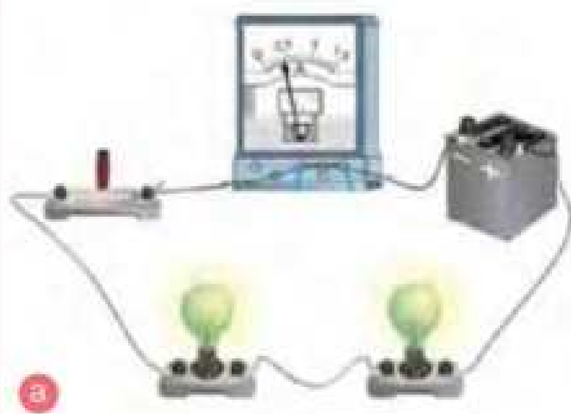
Мал. 27.1. Вимірювання силу струму в електричному колі з послідовним з'єднанням провідників:
