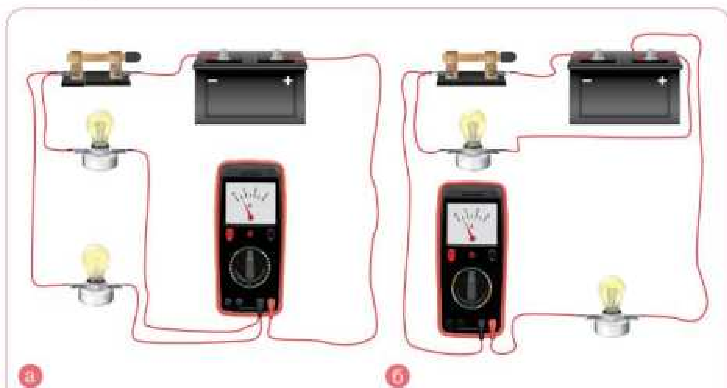
Мал. 28.2. Вимірювання сили струму в колі з паралельним з'єднанням провідників: а — у загальній частині кола, б — на першій лампі, в — на другій лампі
