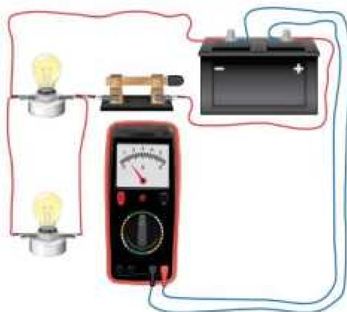
Мал. 28.1. Вимірювання напруги в колі з паралельним з'єднанням провідників:
