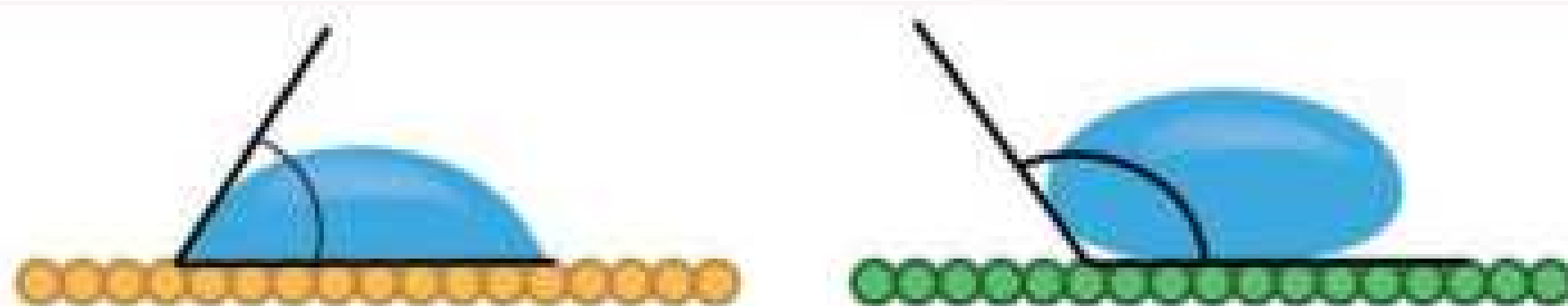
Мал. 9.4. а — рідина змочує поверхню, б — рідина не змочує поверхню.
