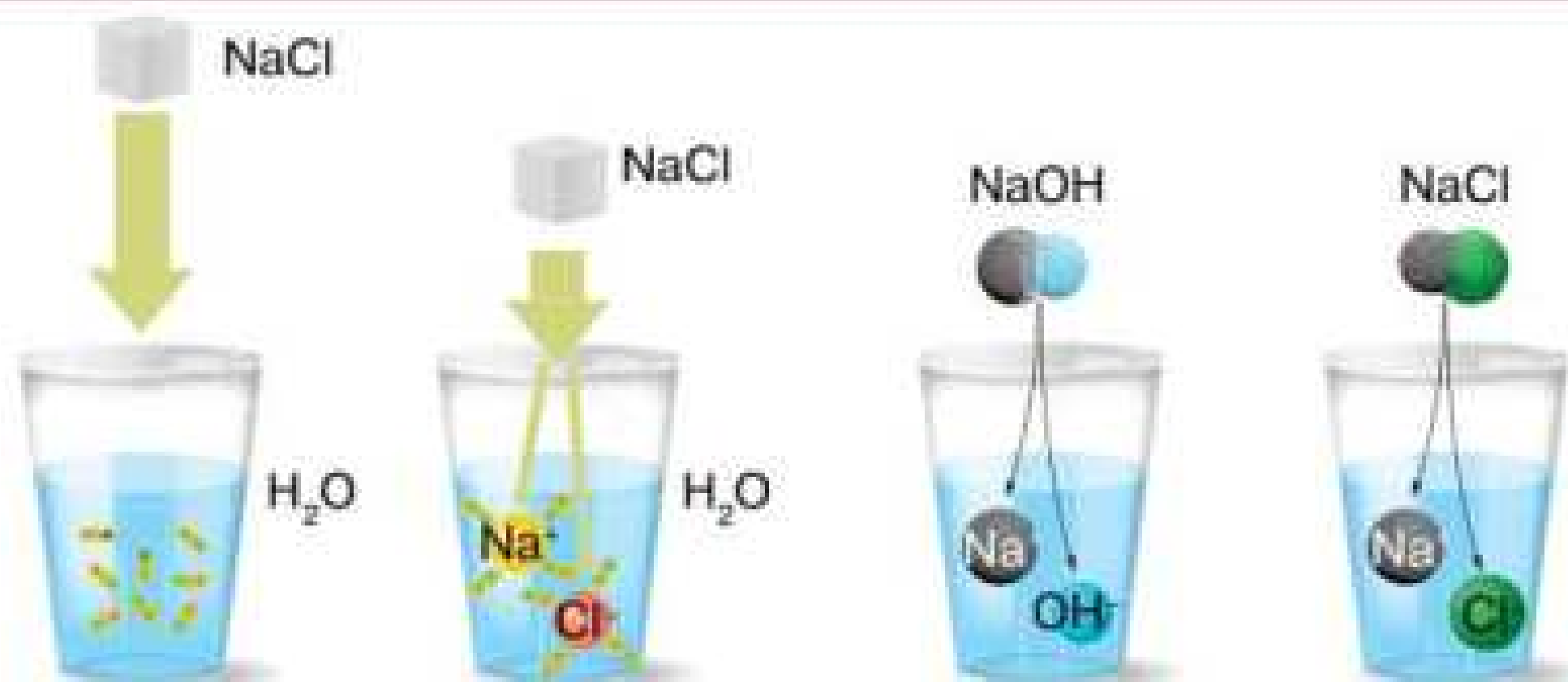
Мал. 31.2. У розчині утворюються вільні носії електричного струму
