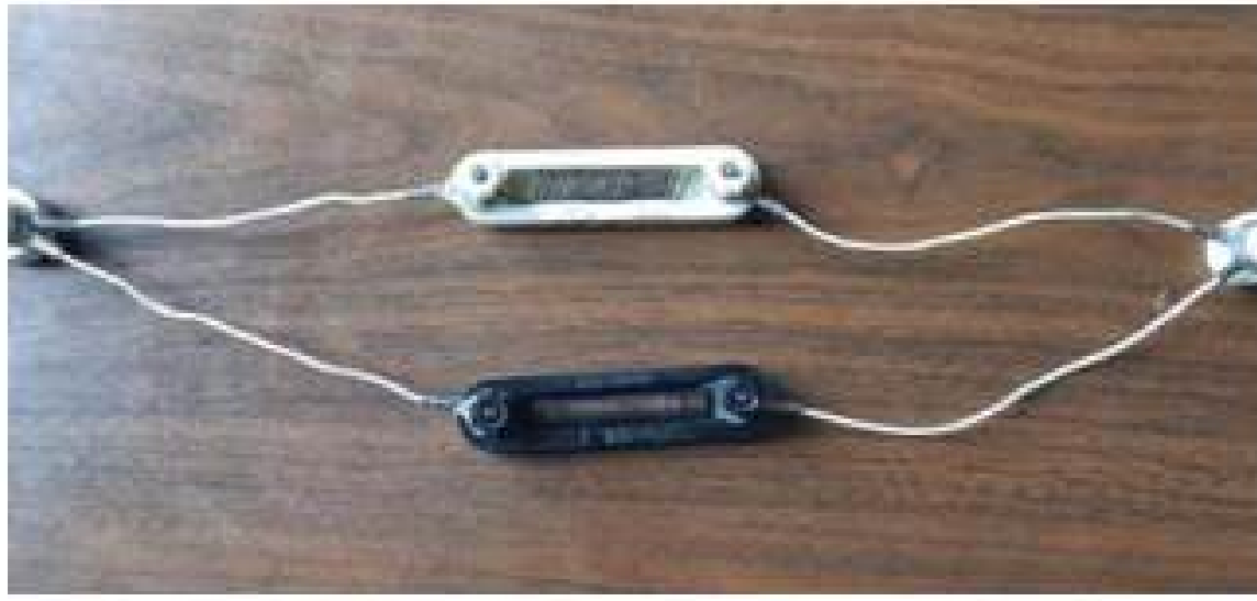
Мал. 29.8. Резистори-спіралі, з'єднані паралельно
