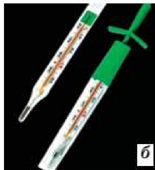
Мал. 1.3. Термометр медичний: а — ртутний; б — безртутний
