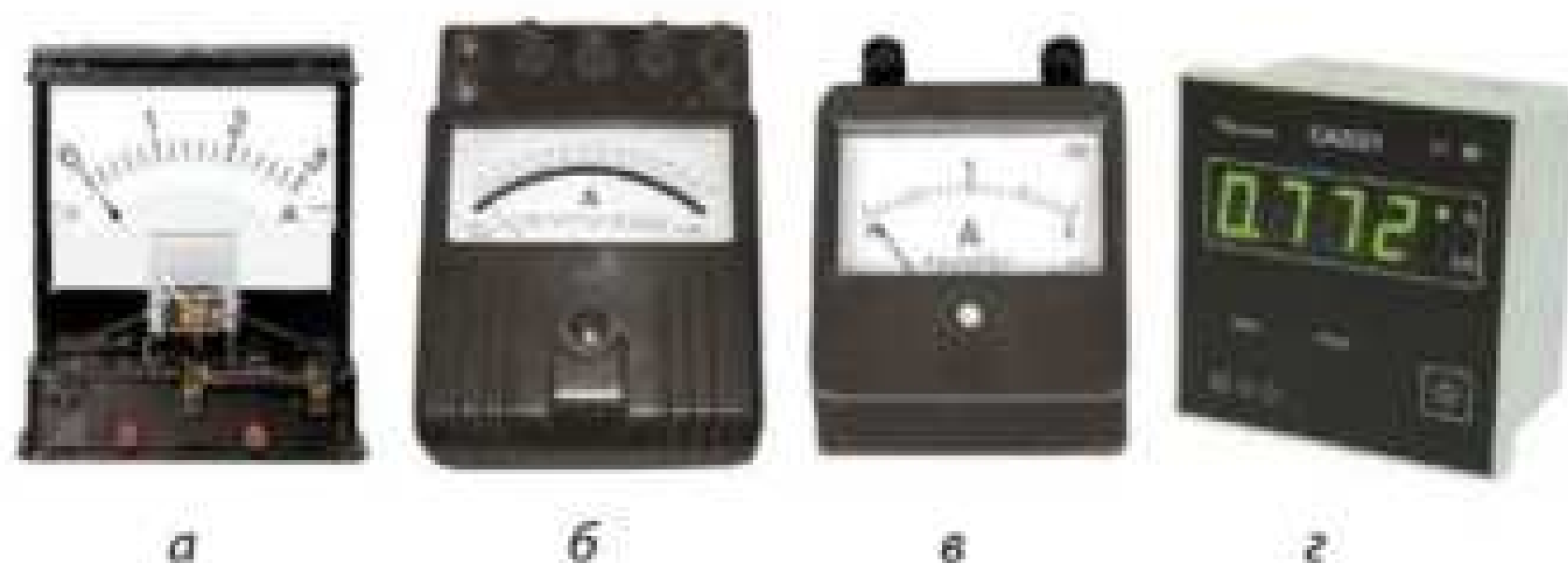
Рис. 35.5. Деякі види амперметрів: а — демонстраційний; б — лабораторний із дзеркальною шкалою; в — шкільний лабораторний; г — електронний
