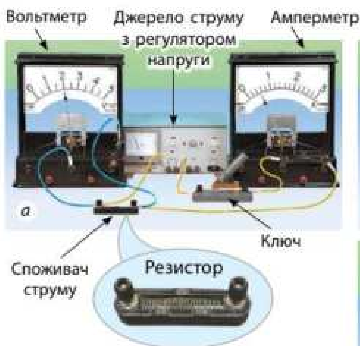
Рис. 37.1. Дослід, який демонструє залежність сили струму в провіднику від поданої на провідник напруги
