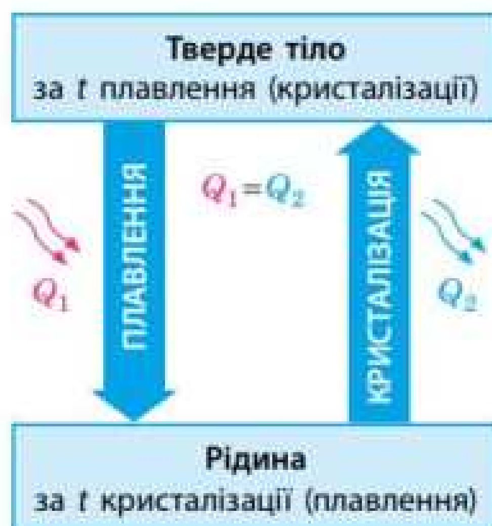
Рис. 20.1. Під час плавлення речовина поглинає таку саму кількість теплоти, яку виділяє під час кристалізації
