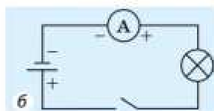
Рис. 35.7. Вимірювання амперметром сили струму, який проходить через нитку розжарення лампи: а — загальний вигляд електричного кола; б — схема
