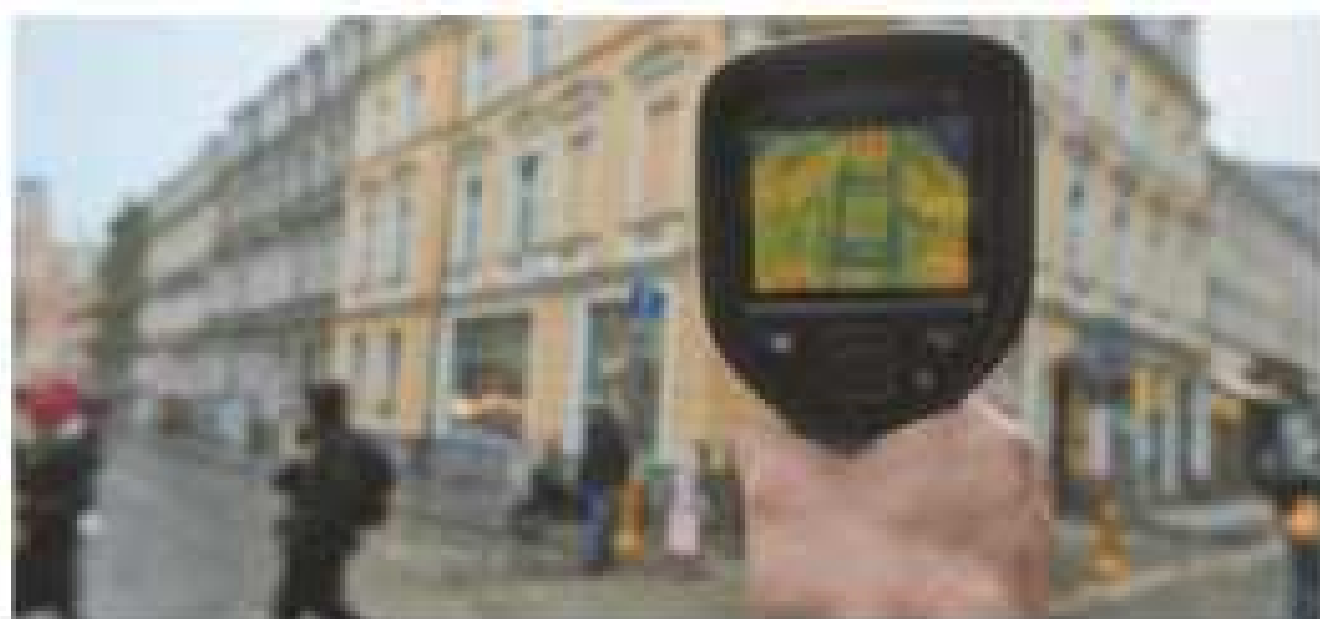
Рис. 15.4. Аналіз енергоефективності будинку за допомогою тепловізора
