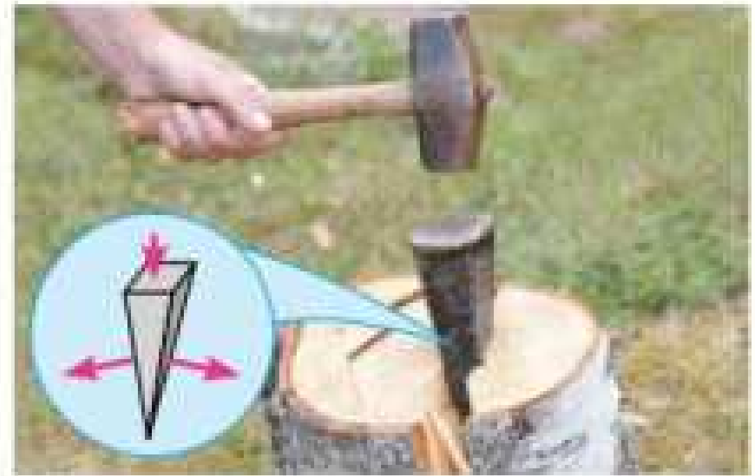
Рис. 1.7. Клин не тільки дає вигоду у силі, а й змінює її напрямок
