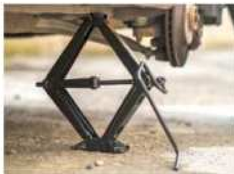
Рис. 1.3. Щоб підняти колесо автомобіля на незначну висоту за допомогою ручного механічного домкрата, людина обертає його ручку, при цьому рука людини долає значну відстань
