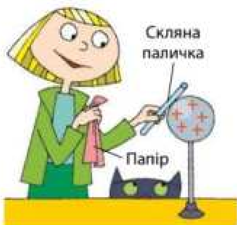
Рис. 28.2. Під час дотику до сфери позитивно зарядженої палички сфера набуває позитивного заряду
