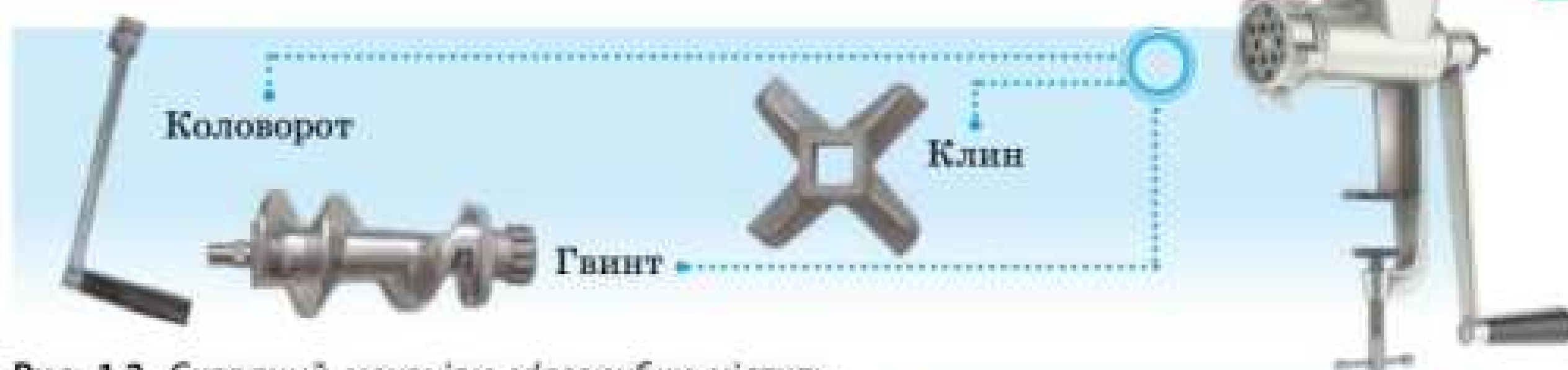
Рис. 1.2. Складний механізм м'ясорубки містить декілька простих механізмів
