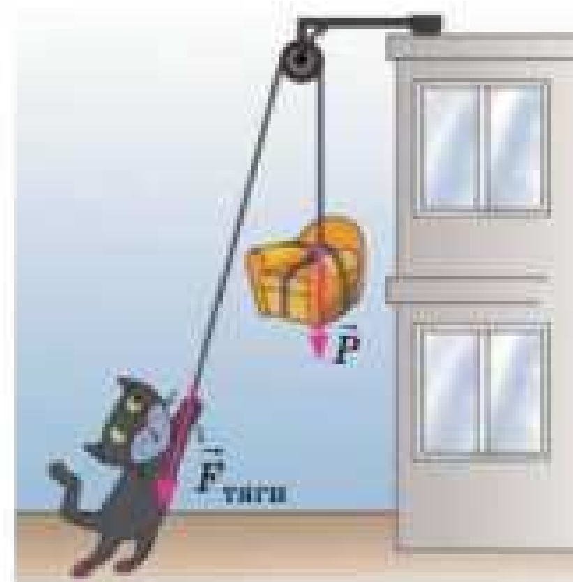
Рис. 6.1. У блоці завжди є тертя, тому сила F , з якою тягнуть мотузку, за значенням більша за вагу P вантажу: F > P
