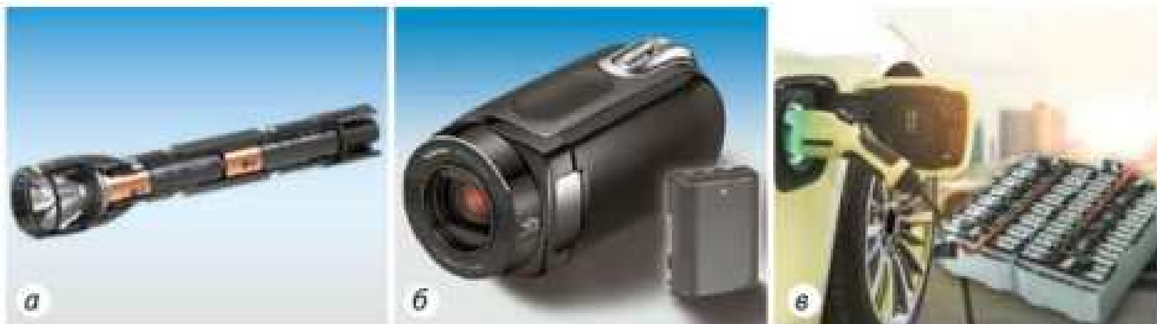
Рис. 33.7. Широко використовувані хімічні джерела електричного струму: батарея гальванічних елементів (а); акумуляторні батареї (б, в)
