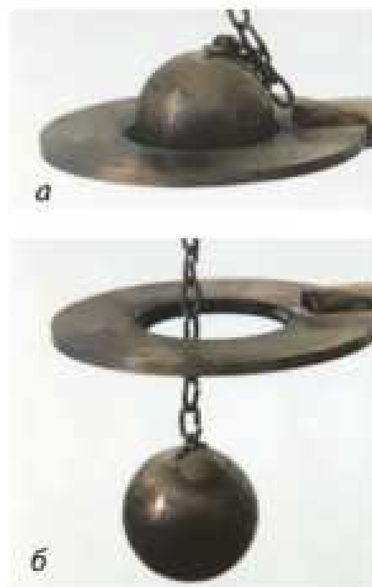
Рис. 11.2. Пристрій Гравезанда: а — у нагрітому стані металева кулька не проходить крізь кільце; б — після охолодження кулька проходить крізь кільце
