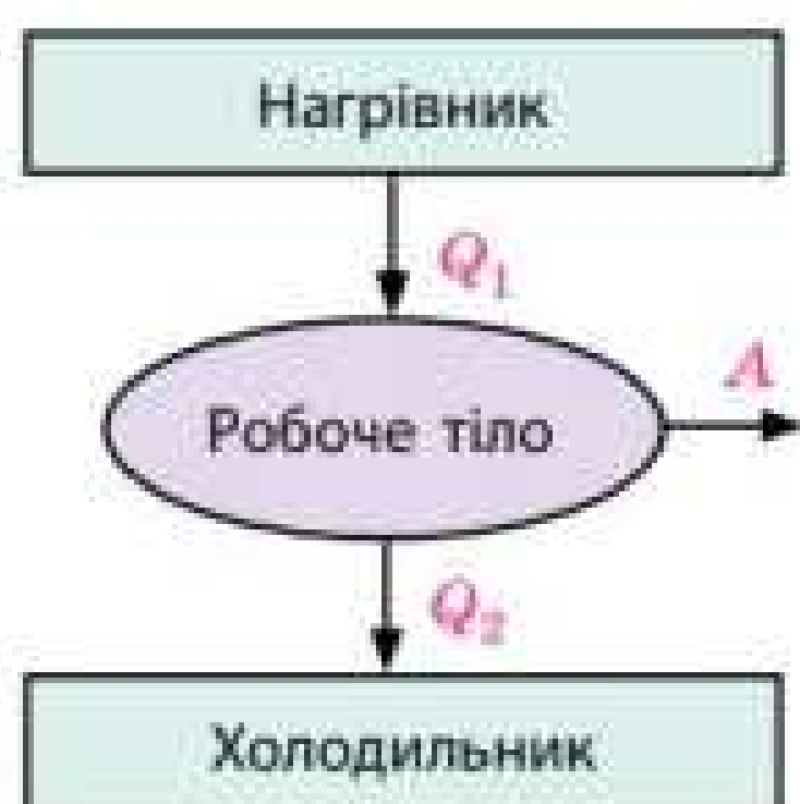
Рис. 24.2. Принцип дії теплових машин: робоче тіло одержує певну кількість теплоти ( Q_1 ) від нагрівника, ця теплота частково перетворюється на механічну енергію (робоче тіло виконує роботу A ), а частково ( Q_2 ) передається холодильнику
