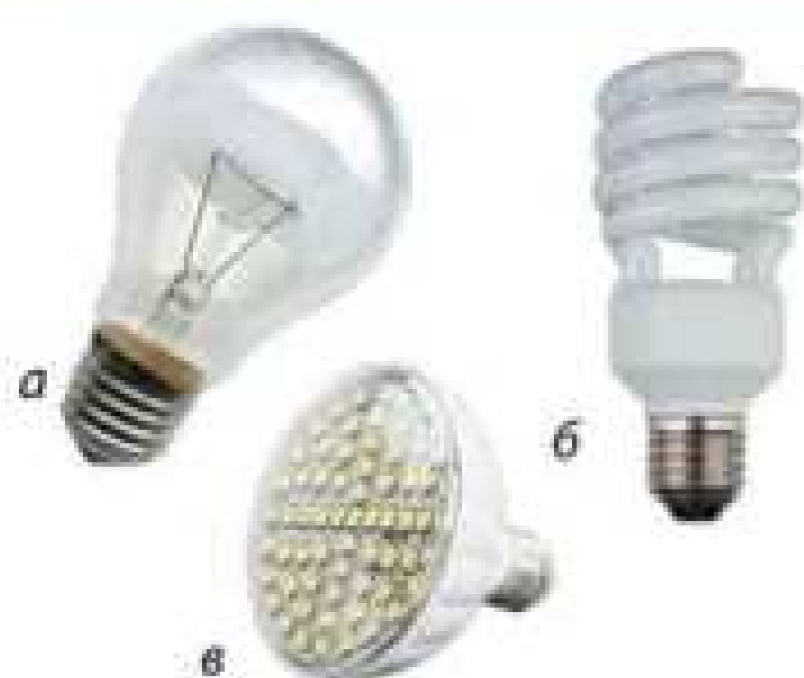
Рис. 32.3. Електричні лампи — пристрої, у яких електрична енергія частково перетворюється на енергію світла: а — лампа розжарення (ККД — 5 %); б — люмінесцентна лампа (ККД — 10–20 %); в — світлодіодна лампа (ККД — 50 %)
