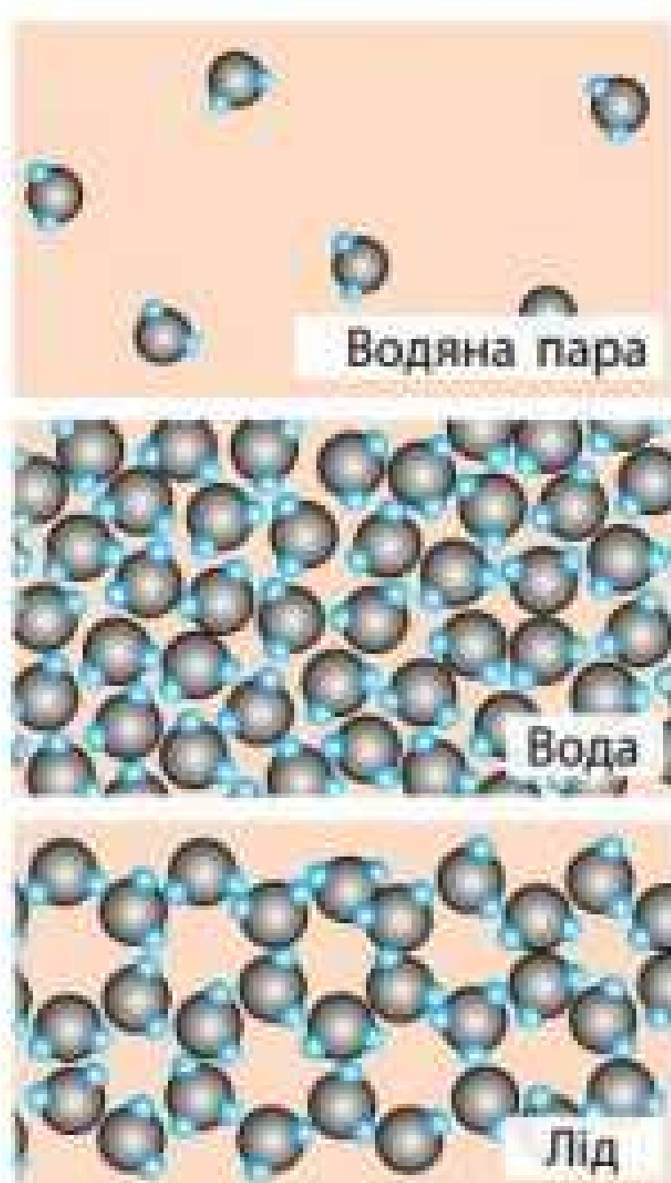
Рис. 12.2. У різних агрегатних станах взаємне розташування молекул речовини є різним, тому відрізняється і потенціальна енергія взаємодії молекул
