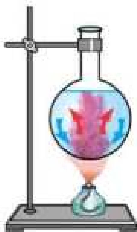
Рис. 14.2. Дослід, який демонструє конвекцію в рідині. Теплі забарвлені струминки води піднімаються, а холодні — опускаються
