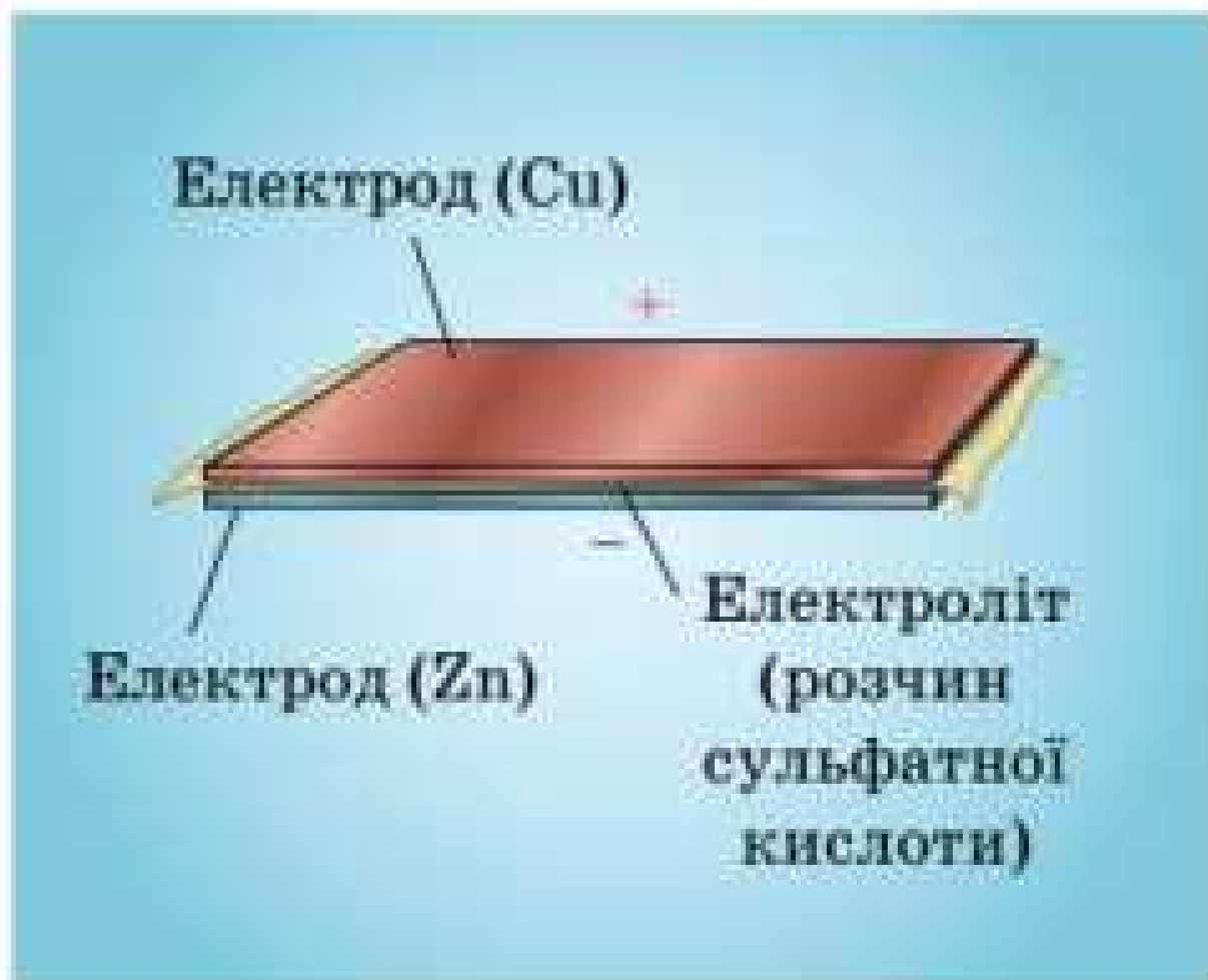
Рис. 33.5. Найпростіший гальванічний елемент
