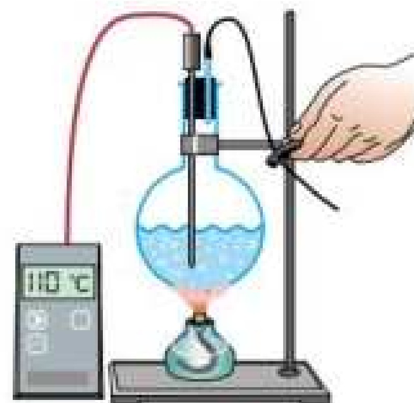
Рис. 22.3. У разі затиснення трубки для відведення пари тиск усередині колби збільшується, і це приводить до підвищення температури кипіння рідини
