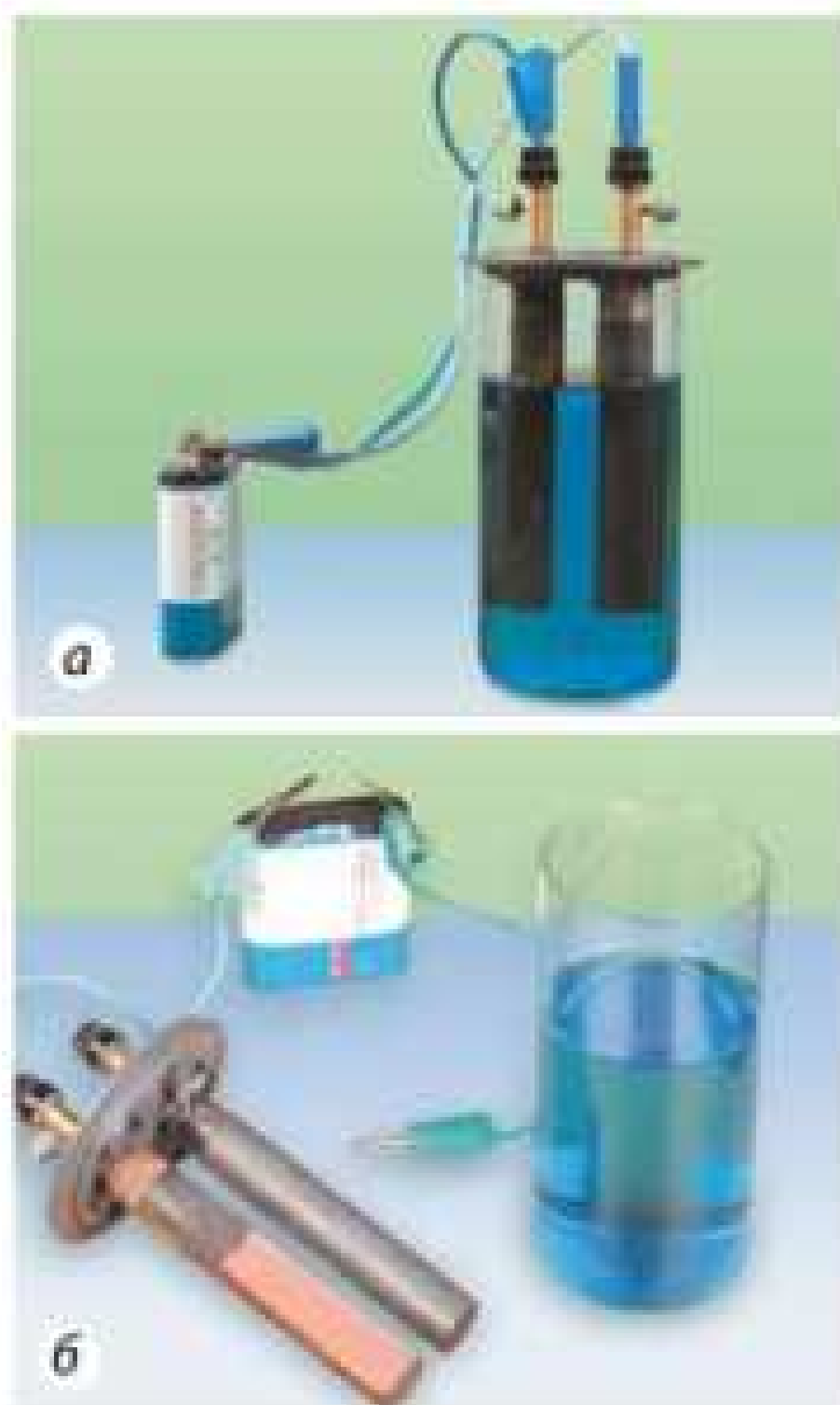
Рис. 32.4. Дослід, який демонструє хімічну дію електричного струму: якщо протягом деякого часу пропускати струм крізь водний розчин сульфату міді (а), на одному з електродів з'явиться тонкий шар міді (б)
