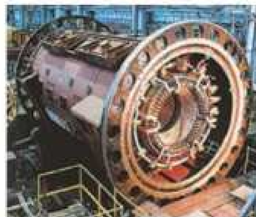
Рис. 33.1. Турбогенератори, що перетворюють механічну енергію обертання турбін на енергію електричного струму, виробляють значну долю споживаної у світі електроенергії
