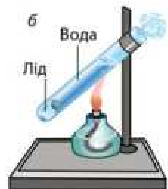
Рис. 13.1. Досліди, які ілюструють низьку теплопровідність деревини (а) та води (б)
