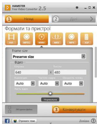
Мал. 4.18. Вікно програми HAMSTER Free Video Converter на етапі встановлення властивостей конвертування файлу
