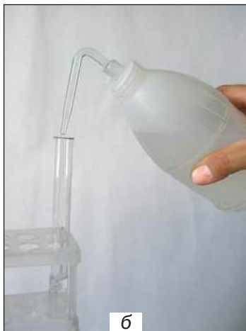
Мал. 10. Промивалка (а) і користування нею (б)
