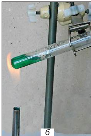
Мал. 25. Нагрівання рідини в пробірці: а — закріплений у пробіркотримачі; б — закріплений у штативі
