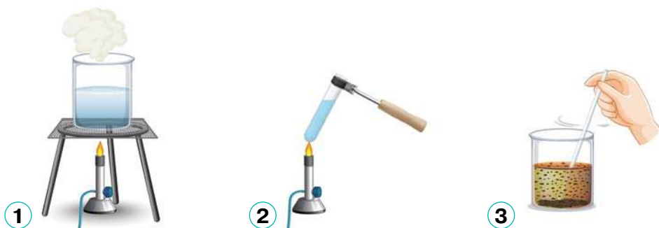
Мал. 2.4. 1. Нагрівання речовини в хімічному стакані. 2. Використання тримача для пробірок запобігає термічному опіку. 3. Перемішувати хімікати скляною чи пластиковою паличкою потрібно обережно, рухами по колу. Не стукай нею по денцю і стінках крихкої посудини!
