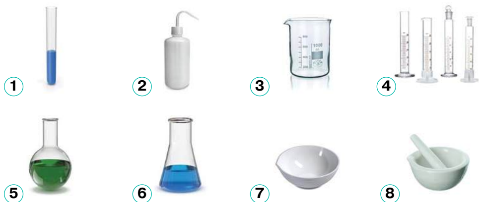
Мал. 2.2. Лабораторний посуд. 1. Пробірка. 2. Промивалка. 3. Хімічний стакан. 4. Мірні циліндри. 5. Круглodonна колба. 6. Конусоподібна колба. 7. Чашка для випарювання. 8. Ступка з товкачиком
