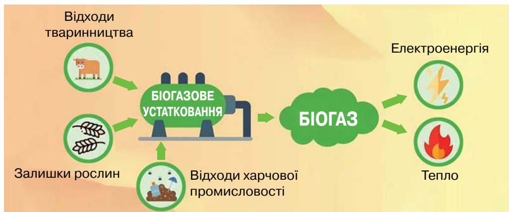
Мал. 14.4. Вироблення біогазу на спеціальних станціях
