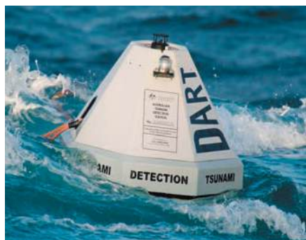
Мал. 272. Поверхневий буй для попередження про цунамі
