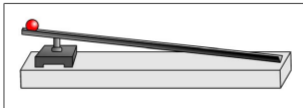
Мал. 39. Вимірювання середньої швидкості руху кульки
