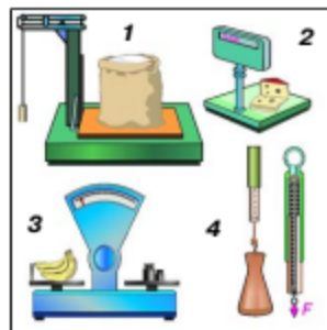
Мал. 63. Терези важільні (1 — десятикові; 2 — електронні; 3 — настільні торговельні) та пружинні (4)
