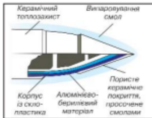
Мал. 21. Схема будови стінки головного блоку космічного корабля
