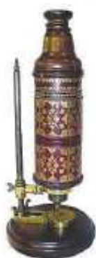
Мікроскоп Роберта Гука (1635–1703) — один з перших інструментів для спостереження за дрібними біологічними об'єктами
