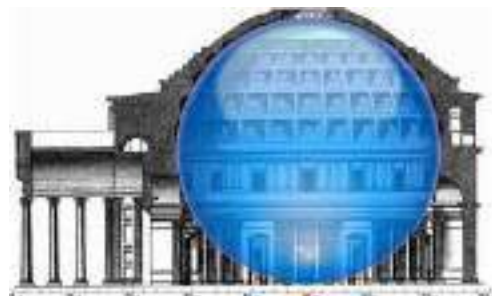
Поперечний розріз Пантеону, схема
