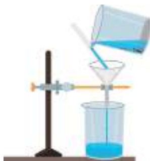
Мал. 19. Розділення суміші води та вугілля фільтруванням
