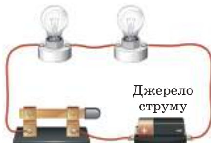
Мал. 10. Електричне коло з послідовним з'єднанням двох ламп
