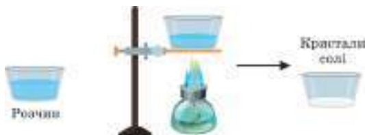
Мал. 17. Етапи процесу випарювання
