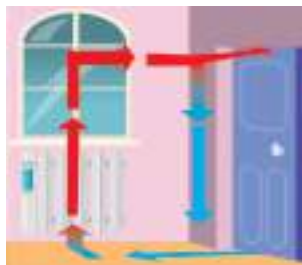
Мал. 4. Рух холодного та теплого повітря під час конвекції
