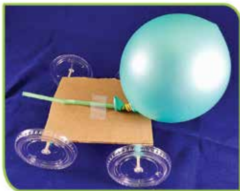
Мал. 19. Саморобні іграшки, що рухаються за принципом реактивного руху
