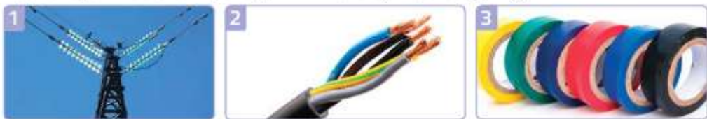
Мал. 28: 1 — ізолятори на лінії високої напруги; 2 — електричні дроти з металу, вкриті ізоляцією з гуми та пластмаси; 3 — ізоляційна стрічка
