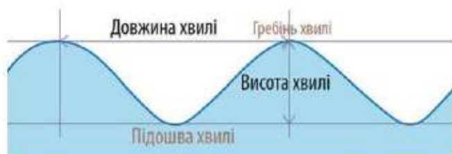
Мал. 186. Визначення висоти й довжини вітрових хвиль
