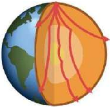
Мал. 52. Сейсмічні хвилі, що розходяться від гіпоцентру землетрусу крізь товщу Землі. За їх допомогою геологи вивчають внутрішню будову Землі
