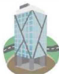
Мал. 54. Додаткові конструкції для будинку на території з високою сейсмічною небезпечкою
