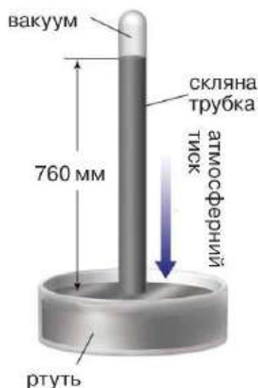
Мал. 124. Схематичне зображення ртутного барометра
