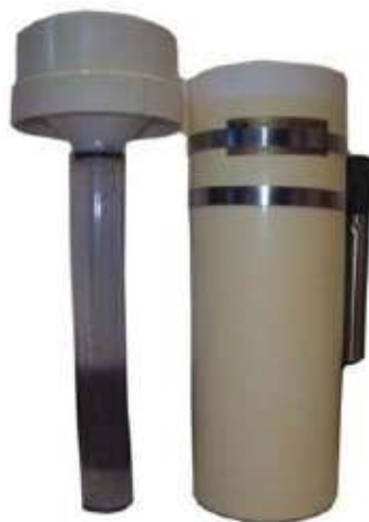
Мал. 147. Вимірювальна склянка і вимірювальне відро опадоміра
