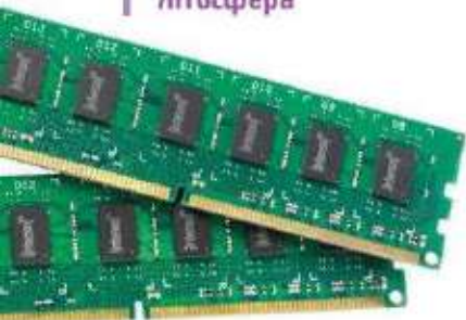
Мал. 86. Позолочені контакти електронних мікросхем
