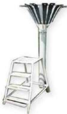
Мал. 148. Спеціальна конструкція для запобігання видування опадів
