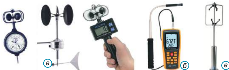
Мал. 176. Анемометри різної конструкції: а – чашкові (механічний та електронні); б – тепловий; в – тривимірний ультразвуковий
