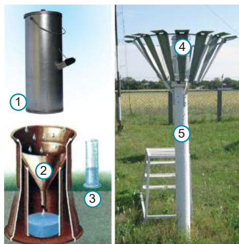
Мал. 203. Будова опадоміра (плювіометра): 1 – дощомірне відро (у нього потрапляють опади); 2 – лійка (установлюється лише влітку для зменшення випаровування води з відра); 3 – дощомірна склянка (у неї з дощомірного відра двічі на добу зливають воду; поділки показують товщину шару опадів у міліметрах); 4 – вітровий захист з 15 металевих пластин; 5 – місце для установки (висотою 1,5–2 м)
