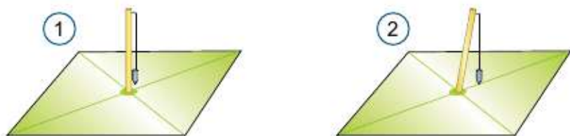
Мал. 11. Модель гномона: 1 – встановлено правильно; 2 – встановлено неправильно
