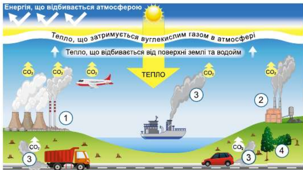
Мал. 136. Парниковий ефект: 1 – теплові електростанції – основне джерело надлишку вуглекислого газу; 2 – спалювання корисних копалин (вугілля, нафти тощо) збільшує надлишок вуглекислоти в атмосфері; 3 – вихлопні гази від транспортних засобів додають вуглекислоти в атмосферу; 4 – вирубування дерев, які поглинають вуглекислий газ
