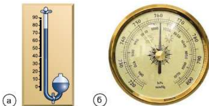
Мал. 98. Барометри: а – ртутний барометр; б – барометр-анероїд
