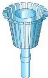
Мал. 6. Опадомір установлюють на стовпі так, щоб його нижній край розташовувався на висоті 2 м над поверхнею Землі.
