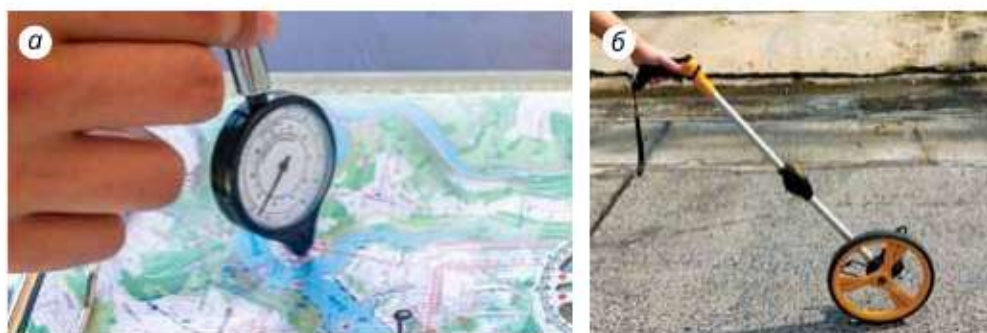
Мал. 4.3. Визначення курвіметром довжини кривих ліній: а — на карті; б — на місцевості
