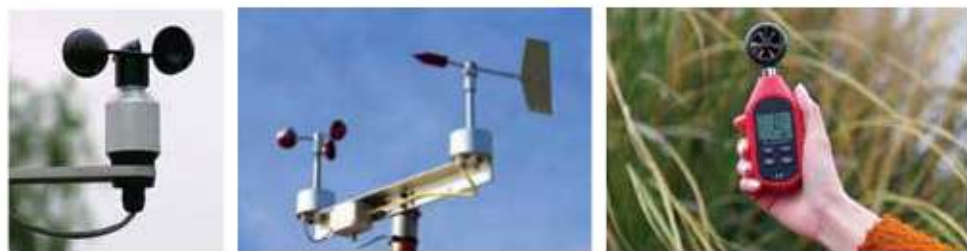
Мал. 18.6. Прилади для вимірювання швидкості й сили вітру та визначення напрямку
