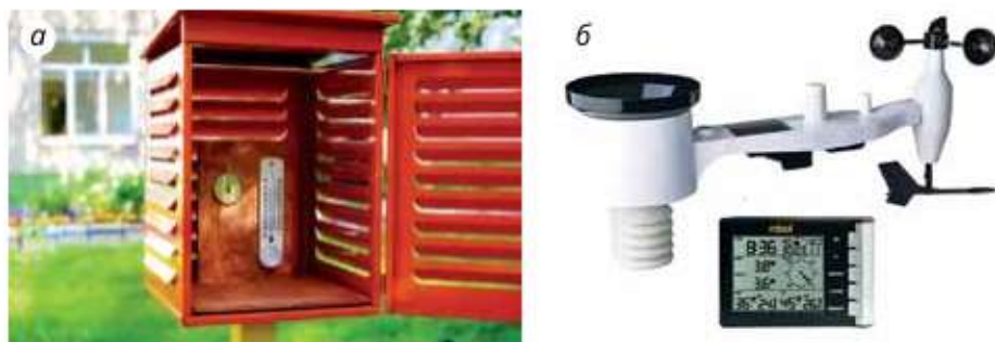
Мал. 16.4. Метеоприлади: а — метеорологічна будка з рідинним термометром; б — автоматизований пристрій
