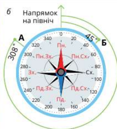
Мал. 6.4. а — орієнтування за компасом; б — визначення азимута
