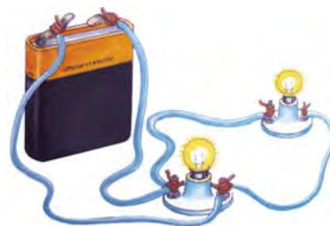
Мал. 33. Паралельне з'єднання лампочок
