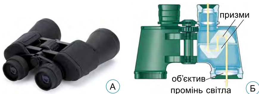
Мал. 117. А. Бінокль для астрономічних спостережень. Б. Внутрішня будова бінокля
