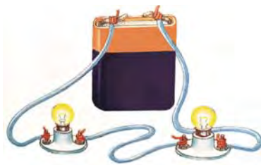
Мал. 32. Послідовне з'єднання лампочок
