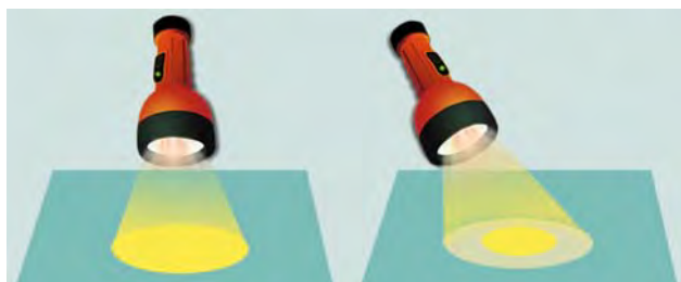
Мал. 82. Вимірювання освітленості поверхні, на яку падає світло під різними кутами
