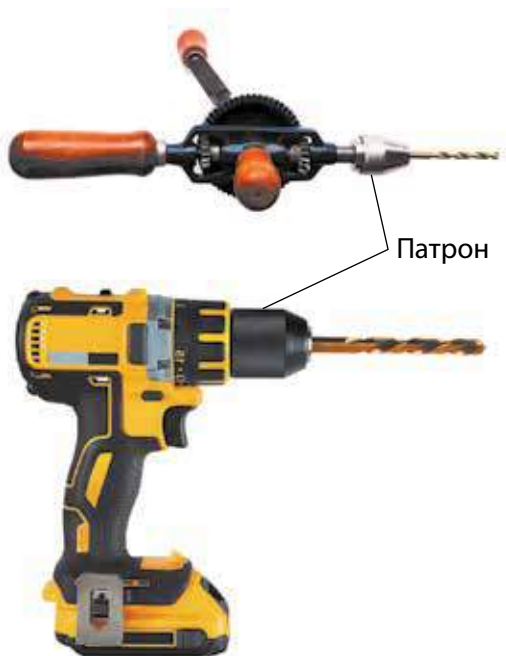
Мал. 9.10. Закріплення свердла в патроні
