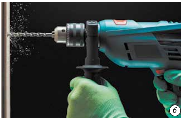
Мал. 9.12. Положення дреля під час свердління
