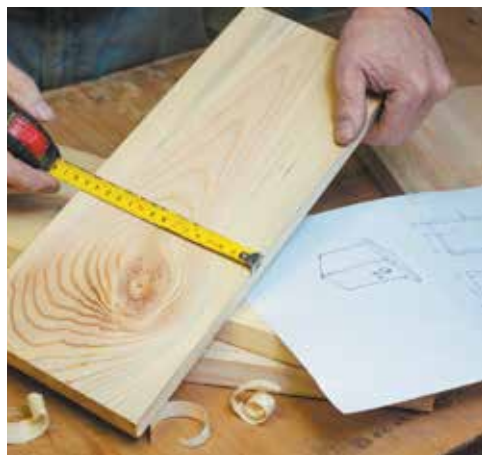
Мал. 7.1. Розмічання розмірів деталей майбутнього виробу
