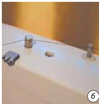
Мал. 10.21. Заправлення верхньої нитки в машину
