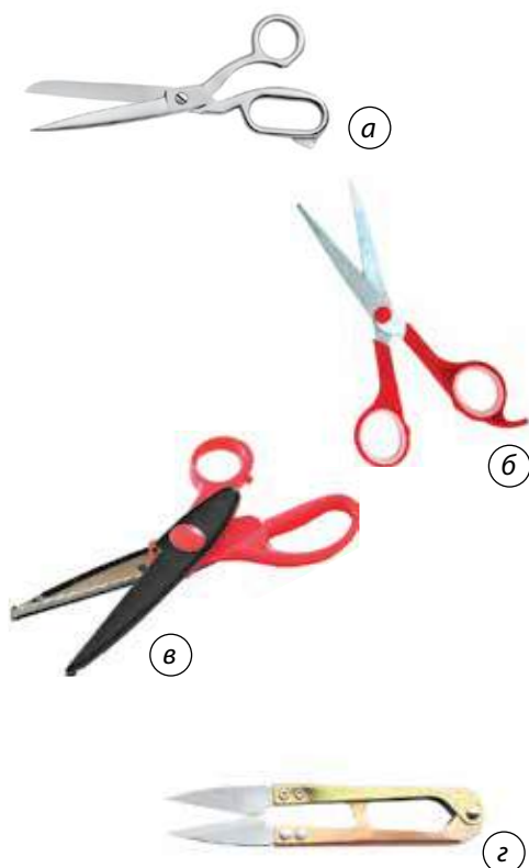
Мал. 10.5. Ножиці: а — кравецькі; б — для паперу; в — із зубчастими лезами; г — для обрізування ниток
