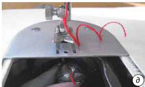
Мал. 10.22. Заправлення нижньої нитки в машину з вертикальним човниковим механізмом
