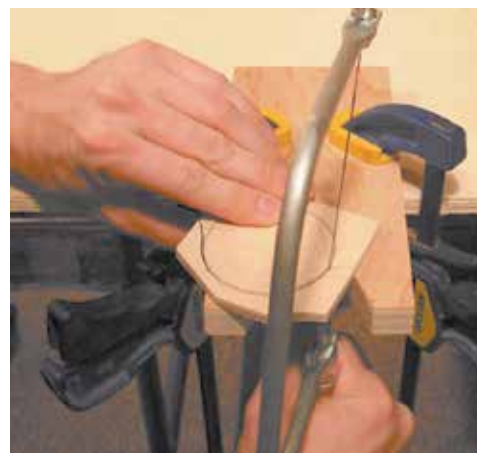
Мал. 9.8. Випилювання по зовнішньому контуру
