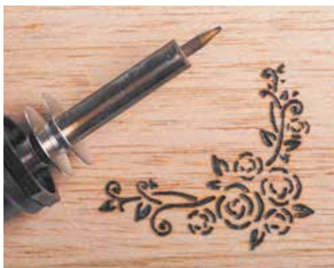
Мал. 9.16. Електровипалювач та робота з ним
