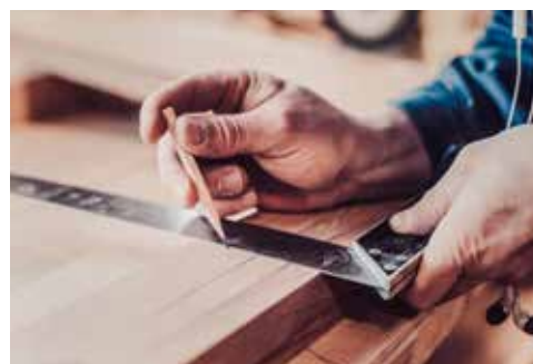
Мал. 7.2. Розмічальні лінії краще наносити за допомогою лінійки, а розмічати можна як дерево, так і тканину
