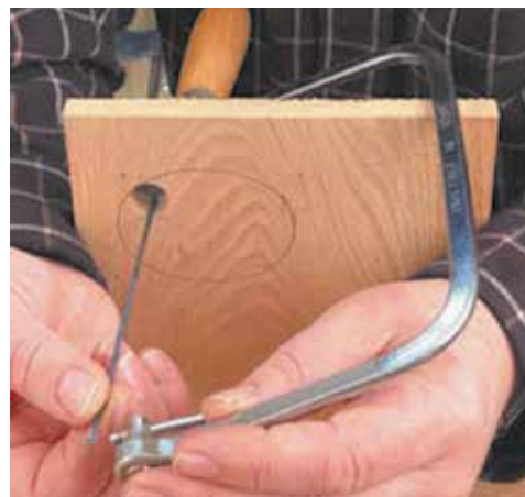
Мал. 9.9. Закріплення пилочки для випилювання внутрішнього контура
