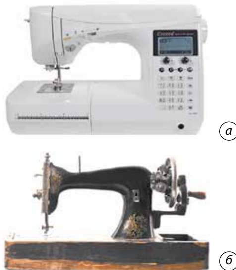
Мал. 4.2. Приводні механізми швейної машини: а — швейна машина з електричним приводом; б — швейна машина з ручним приводом
