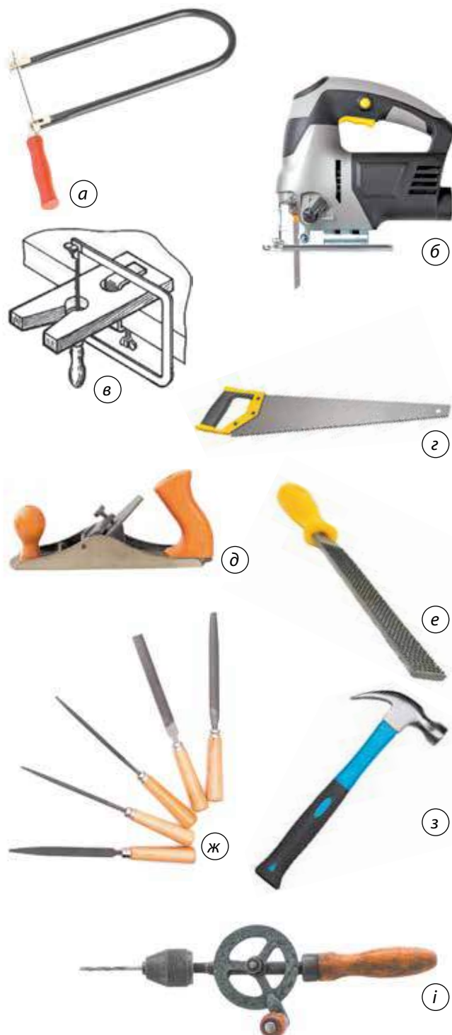
Мал. 9.2. Інструменти для обробки деревинних матеріалів: а — лобзик ручний; б — лобзик електричний; в — підставка для випилювання та кріплення; г — ножівка; д — рубанок; е — рашипель; ж — надфіль; з — молоток; і — дріль ручний
