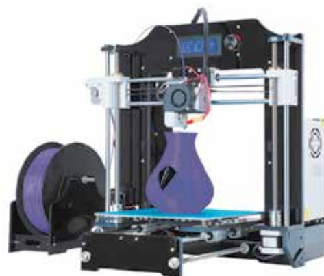
Мал. 4.6. 3D-принтер та виріб, виготовлений ним
