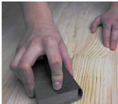
Мал. 9.14. Закріплення наждачного паперу на бруську
