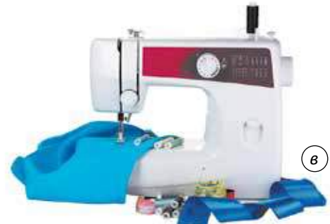
Мал. 10.20. Швейні машини з різними приводами: а — ручним; б — ножним; в — електричним
