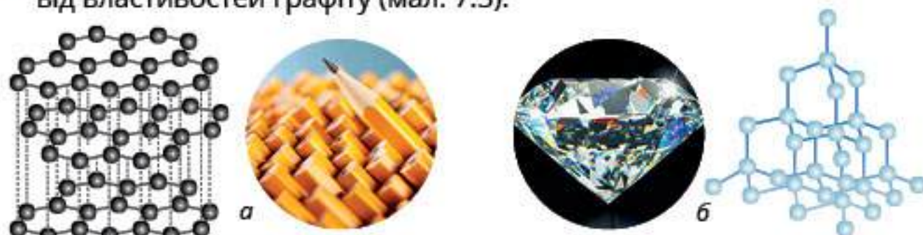
Мал. 7.3. У графіті (а) й алмазі (б) атоми Карбону розташовані в різний спосіб
