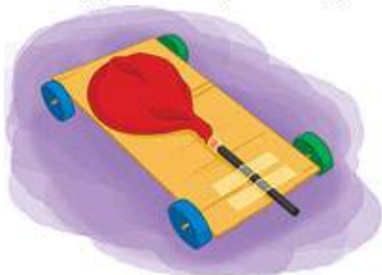
Мал. 18.8. Реактивна «автівка» власноруч!
