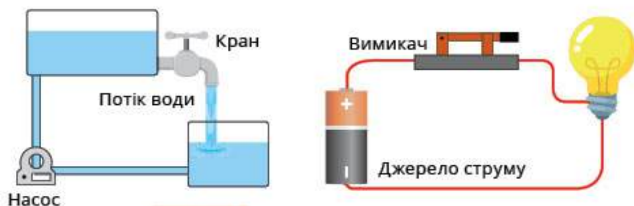
Мал. 39.3. Батарейка працює наче насос, що піднімає воду у верхній бак
