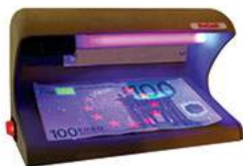
Мал. 33.5. Справжні чи ні? Допоможе з'ясувати ультрафіолет
