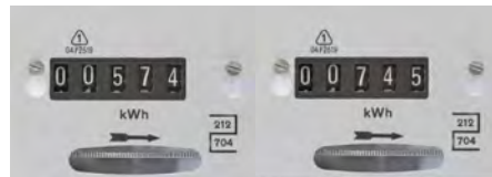
Мал. 71.4. За показаннями електролічильника на початку та наприкінці місяця можна визначити кількість спожитої електроенергії: 745 - 574 = 171 \text{ kWh}
