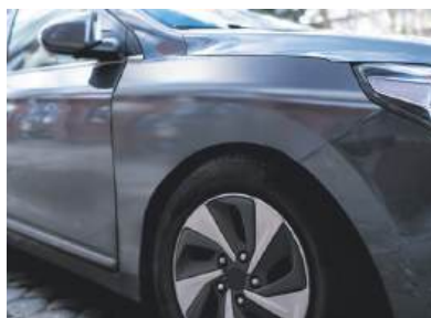
Мал. 26.8. Унаслідок зіткнення з іншим автомобілем крило машини зазнало значних пластичних деформацій
