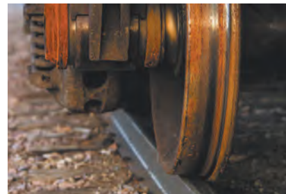
Мал. 26.3. Деформація автомобільного колеса помітніша, ніж у колеса залізничного вагона, через різні властивості цих коліс
