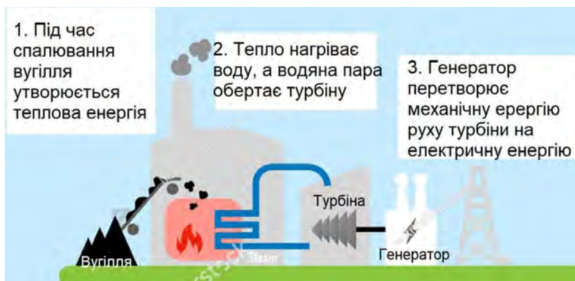
Мал. 74.2. Перетворення енергії спалювання вугілля на електричну
