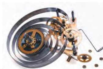
Мал. 36.6. Нерухома стиснута пружина має енергію і може виконати роботу, наприклад, у механічних годинниках
