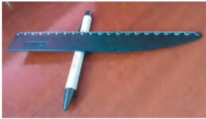
Мал. 37.5. Саморобний важіль з лінійки та ручки
