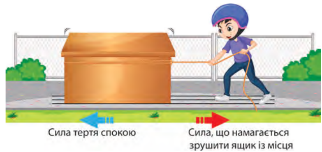
Мал. 29.5. Сила тертя спокою й зовнішня сила: вони дорівнюють одна одній і спрямовані протилежно
