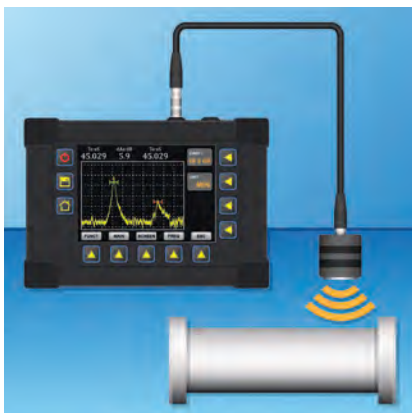
Мал. 60.3. Ультразвук допомагає виявляти дефекти всередині деталей
