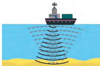
Мал. 60.2. Сонар дозволяє визначити глибину моря
