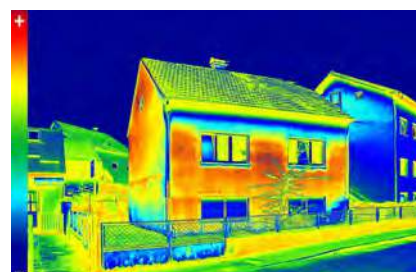
Мал. 74.5. Застосовуючи спеціальні прилади, можна «побачити» витоки тепла з неутепленої будівлі
