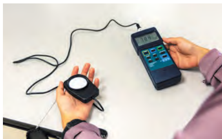
Мал. 51.3. Люксметр дозволяє виміряти освітленість будь-якої поверхні
