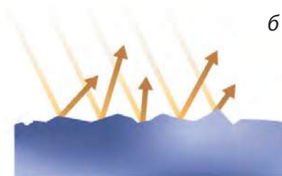
Мал. 53.6. Відбиття світлових променів від дзеркальної (а) та шорсткої (б) поверхні
