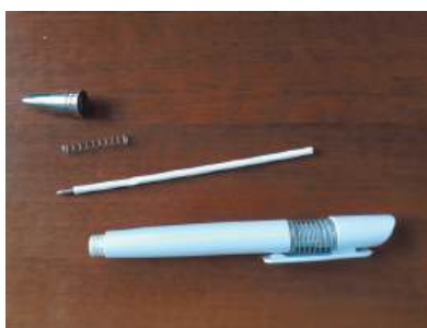
Мал. 26.5. Саме пружина дозволяє працювати механізму автоматичної ручки
