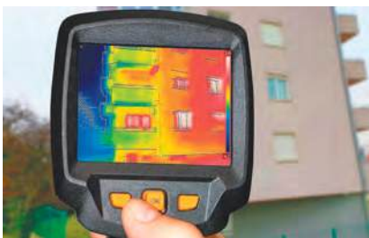
Мал. 42.6. Спеціальні прилади за допомогою теплового випромінювання дозволяють нам бачити у темряві, проводити дослідження втрат тепла в будівлях
