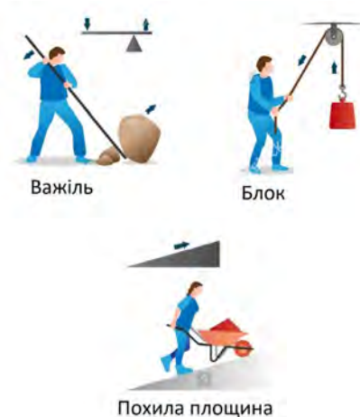
Мал. 75.1. Важіль та похила площина дають виграш у силі, а блок дозволяє змінити напрямок дії сили на зручний
