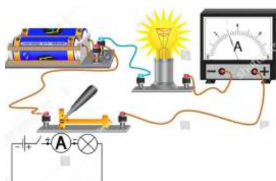
Мал. 67.1. Щоб виміряти силу струму в лампочці, амперметр приєднують до неї послідовно
