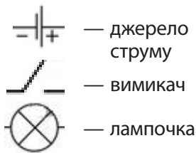
Мал. 66.2. Умовні позначення деяких елементів електричного кола
