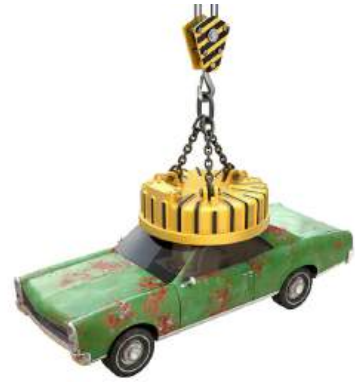
Мал. 68.4. Крани з потужними електромагнітами переносять металеві вантажі
