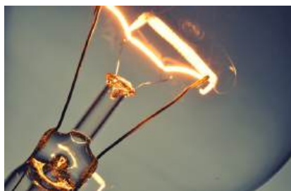
Мал. 68.1. У лампах розжарювання вольфрамова нитка нагрівається електричним струмом до високої температури і починає світитися біло-жовтим світлом
