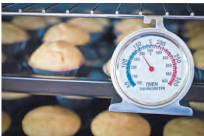
Мал. 48.7. Дія металевих термометрів ґрунтується на тепловому розширенні тіл
