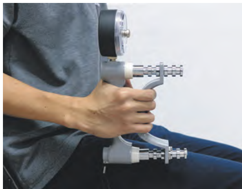
Мал. 27.6. За допомогою динамометрів можна вимірювати силу м'язів рук
