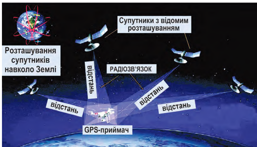
Принцип роботи GPS-приладу (на прикладі визначення положення квадрокоптера)
