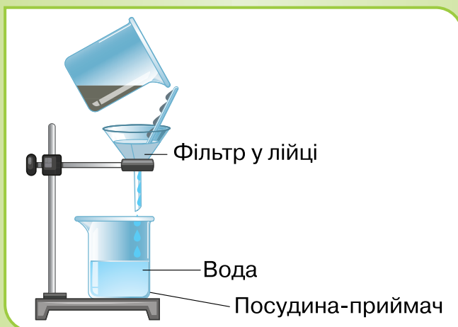
Мал. 30. Розділення сумішей фільтруванням
