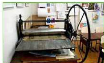
Верстат для відтиску зображення на папері (офортний верстат)
