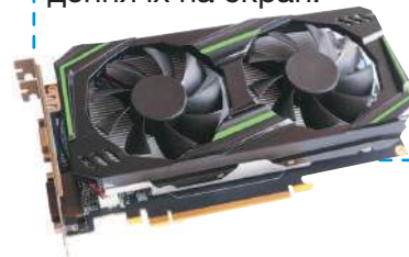
Відеокарта — пристрій для опрацювання графічних даних та виведення їх на екран.
