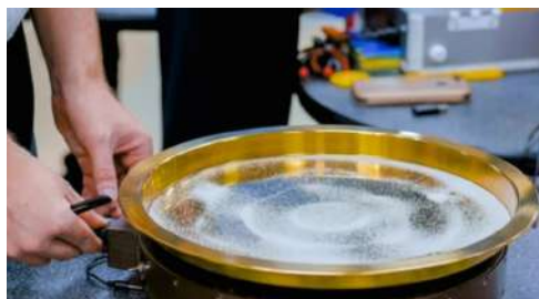
Мал. 42.4. Металевий таз із білим піском поставлено на джерело звуку (динамік). Звукові коливання від динаміка передаються піску, і ми «бачимо» звук
