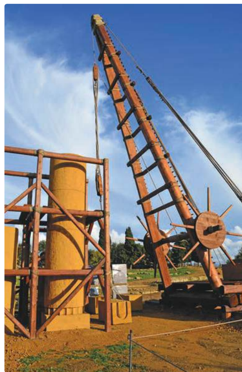
Давньогрецький підйомний кран (реконструкція)
