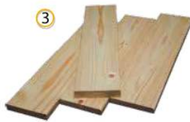
Мал. 1. У виробництві деревину використовують переважно у вигляді пиломатеріалів: рейок (1), брусів (2), дощок (3)
