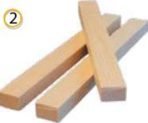
Мал. 1. У виробництві деревину використовують переважно у вигляді пиломатеріалів: рейок (1), брусів (2), дощок (3)
