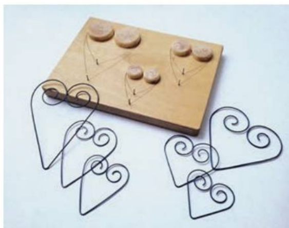
Каркас для формування виробів із дроту
