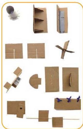
Методи кріплення деталей з картону
